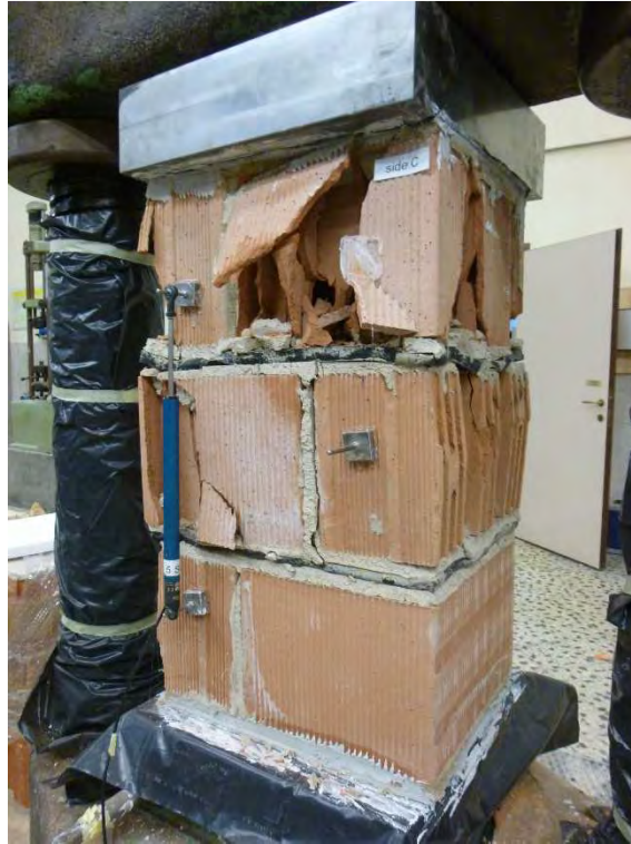
Figura 82 - Risultato Finale per Pilastrino con Giunti in Gomma.
