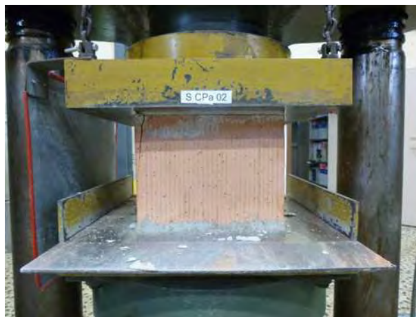
Figura 73 - Test per la Resistenza a Compressione in Direzione \parallel ai Fori.
