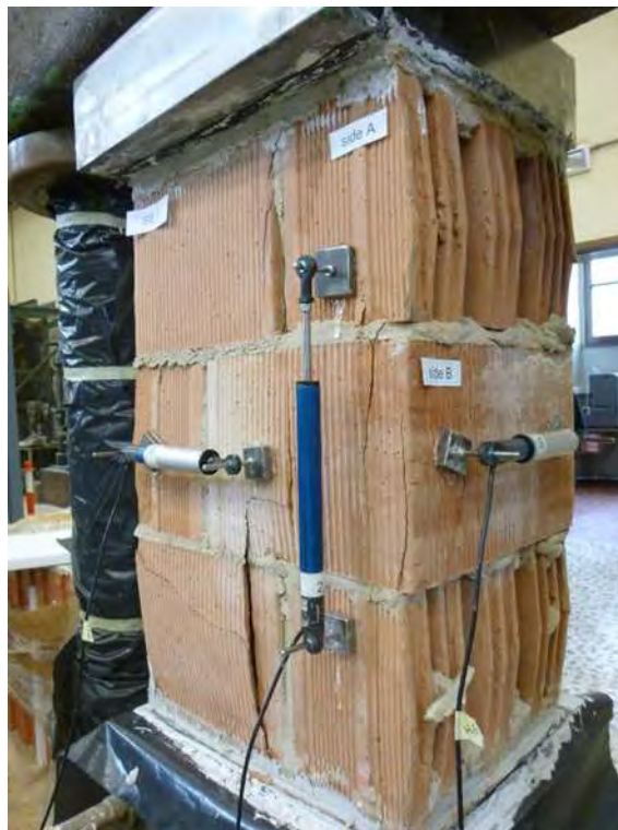
Figura 81 - Fessure Verticali per il Pilastrino con Giunti Ordinari.
