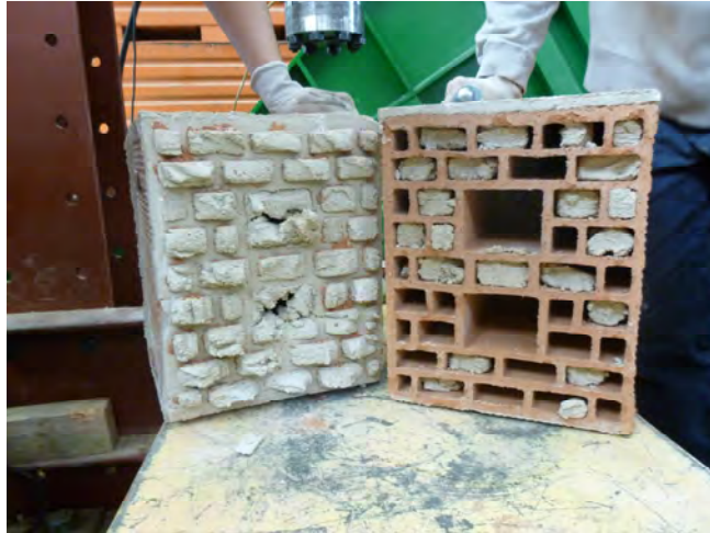
Figura 78 - Modalità di Collasso per Giunto in Malta.
