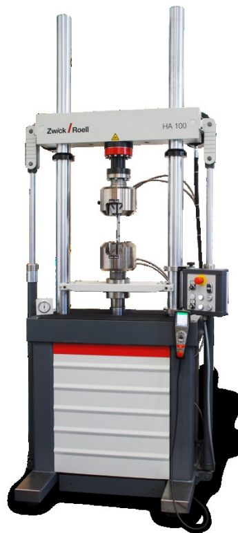
Figura 5.5 Macchina di prova utilizzata per eseguire i test di fatica
