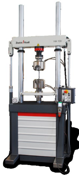
Figura 6.7 Macchina di prova utilizzata per eseguire i test di fatica
