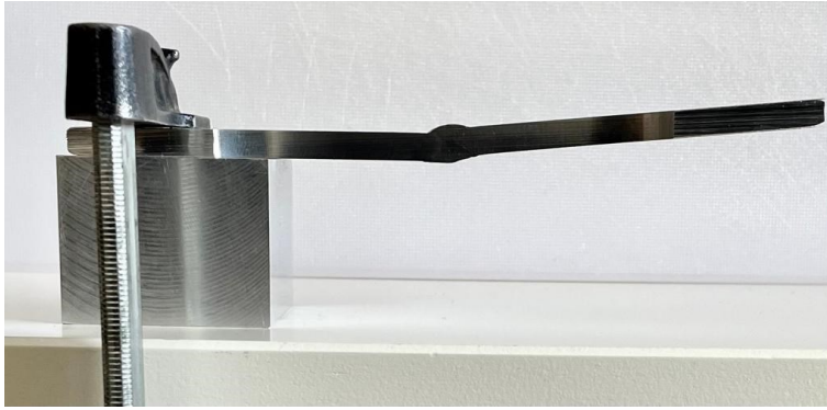
Figura 4.27 Sistema di bloccaggio dei provini nel banco di misura
