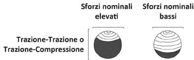
Figura 7.4 Schema di una superficie di frattura per fatica al variare dell'entità del carico applicato [32]
