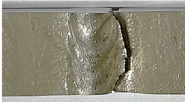
Figura 7.15 Rottura al piede cordone di saldatura
