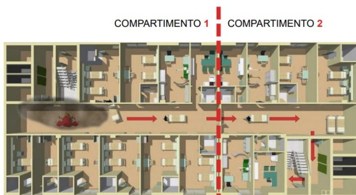
Figura 1.5. Rappresentazione dell'esodo orizzontale progressivo in due compartimenti, nel compartimento 1 vi è l'ennesco e le frecce indicano l'esodo verso il compartimento 2
