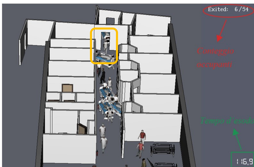
Figura 5.14. Frame del video per valutare il tempo d'esodo; in giallo è evidenziato il flusso in entrata e in uscita dalla porta numero 20
