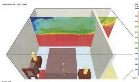
Figura 3.5. rappresentazione di uno slices raffigurante le temperature di una sezione del compartimento
