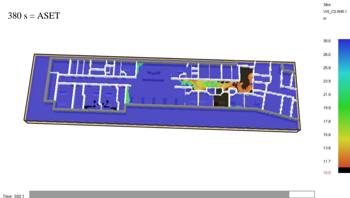
Figura 5.4.a. Soglia di visibilità = 10 m; rappresentazione dell’andamento della visibilità nel tempo con indisponibilità delle vie d’esodo e determinazione del tempo di ASET
