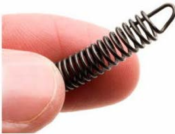
Fig. 1.10: Tipica molla costituita di materiale SMA. Immagine tratta da https://www.explainthatstuff.com/how-shape-memory-works.html
