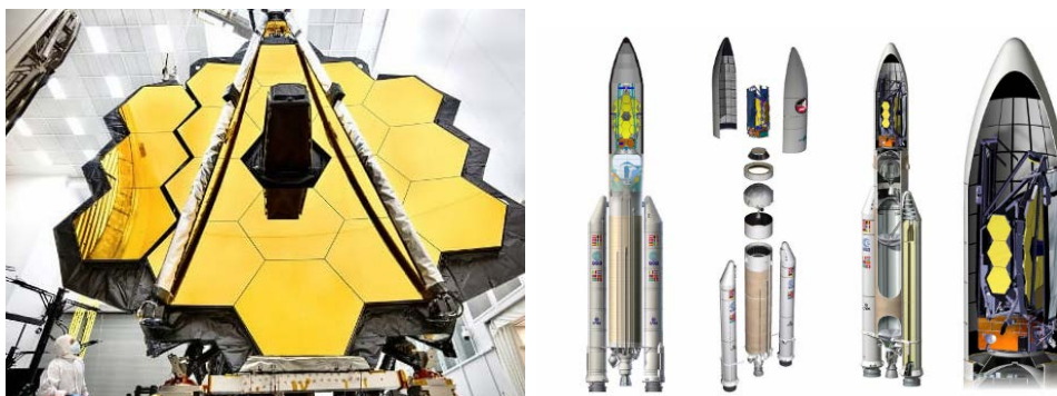
Fig. 1.6: Illustrazione del telescopio Webb. A sinistra la forma dispiegata mentre a destra la forma compatta per il lancio. Immagine tratta da http://www.lescienze.it/news/2018/06/28/news/ritardo_lancio_telemoscopio_spaziale_webb_costi-4030908/ e https://www.tomshw.it/altro/pronto-james-webb-il-telescopio-spaziale-migliore-di-sempre/
