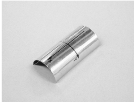
Fig. 4.9: Lamina di BeCu dotata di una curvatura.[13]
