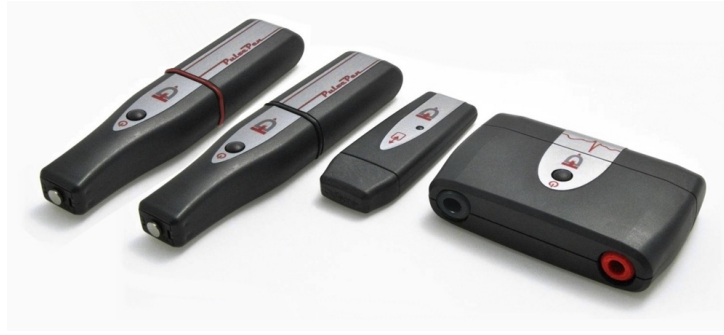
Figura 2.1: Rappresentazione del dispositivo PulsePen ® . Da sinistra: due sonde tonometriche; memoria USB contenente PC Software, tutorial e manuale; unità ECG con il collegamento di soli due elettrodi.
