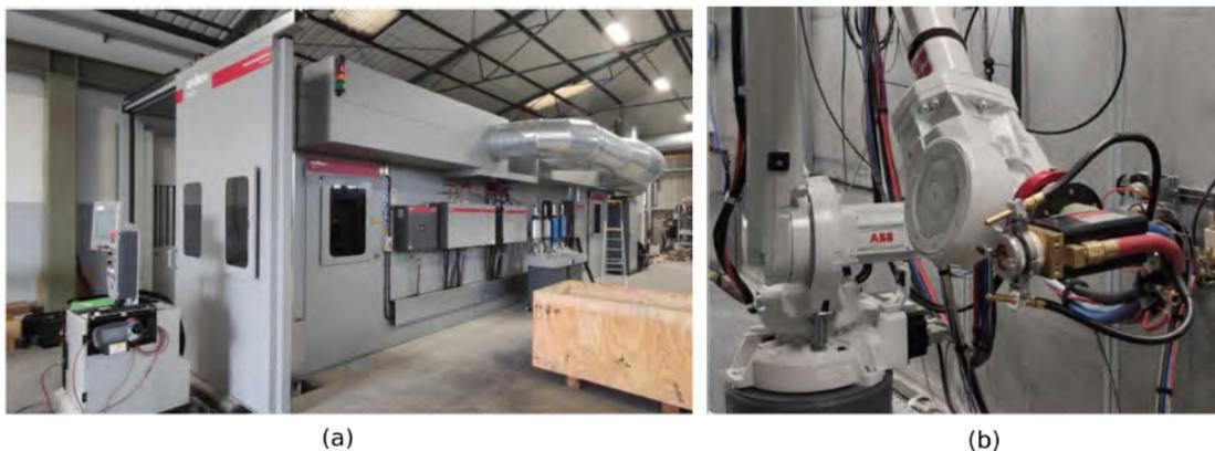
**Figura 4.1:** Impianto multicoat Oerlikon Metco utilizzato per le deposizioni APS (a) e Particolare del braccio robotico ABB su cui è montata la torcia plasma spray Metco F4MB-XL (b).
