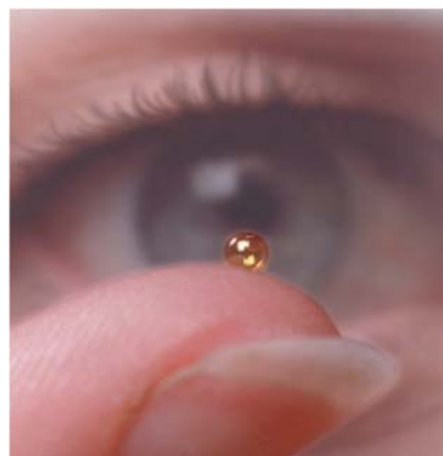
Figura 1-15: dimensioni del pellet utilizzato in un reattore a fusione inerziale.
