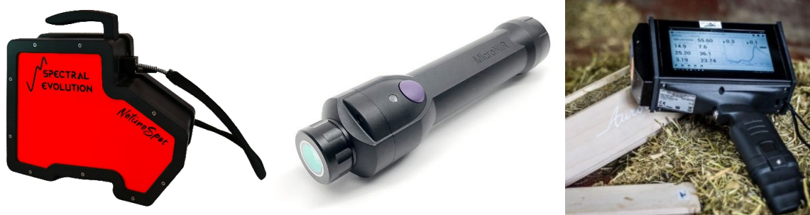
Figura 2.3 Alcuni esempi di spettrometri NIR portatili: a sinistra, NarutaSpec (Spectral Evolution). Al centro MicroNir (ITPhotonics). A destra Aurora (Grainit).
