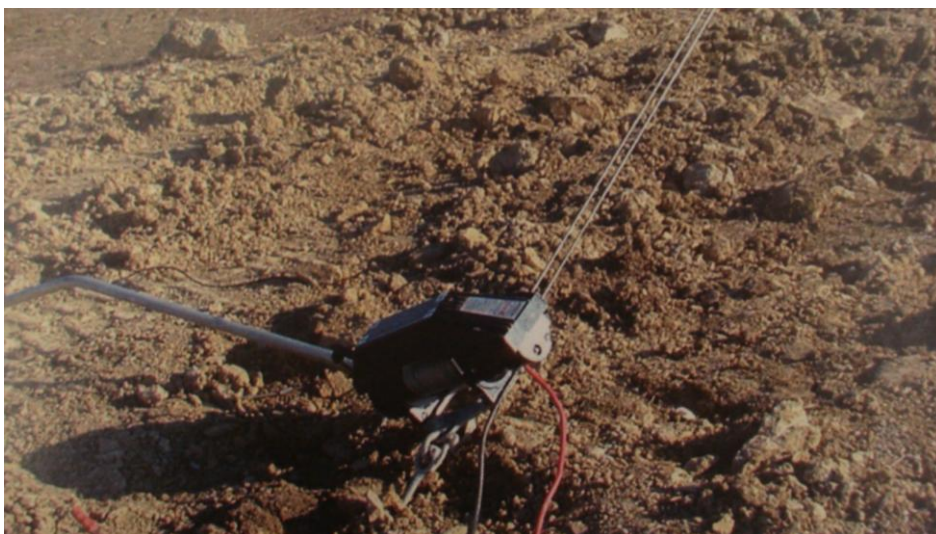
Figura 2.18 – Particolare dell'ancoraggio del verricello
