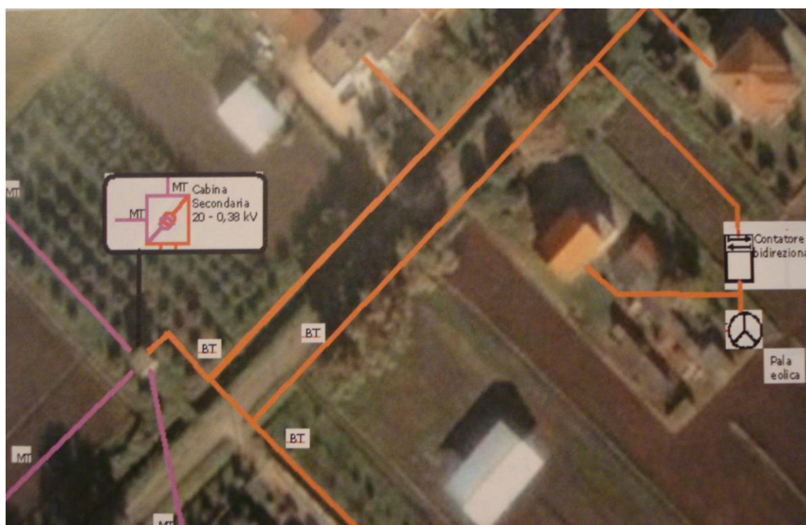
Figura 1.33 – Connessione di impianti eolici in BT
