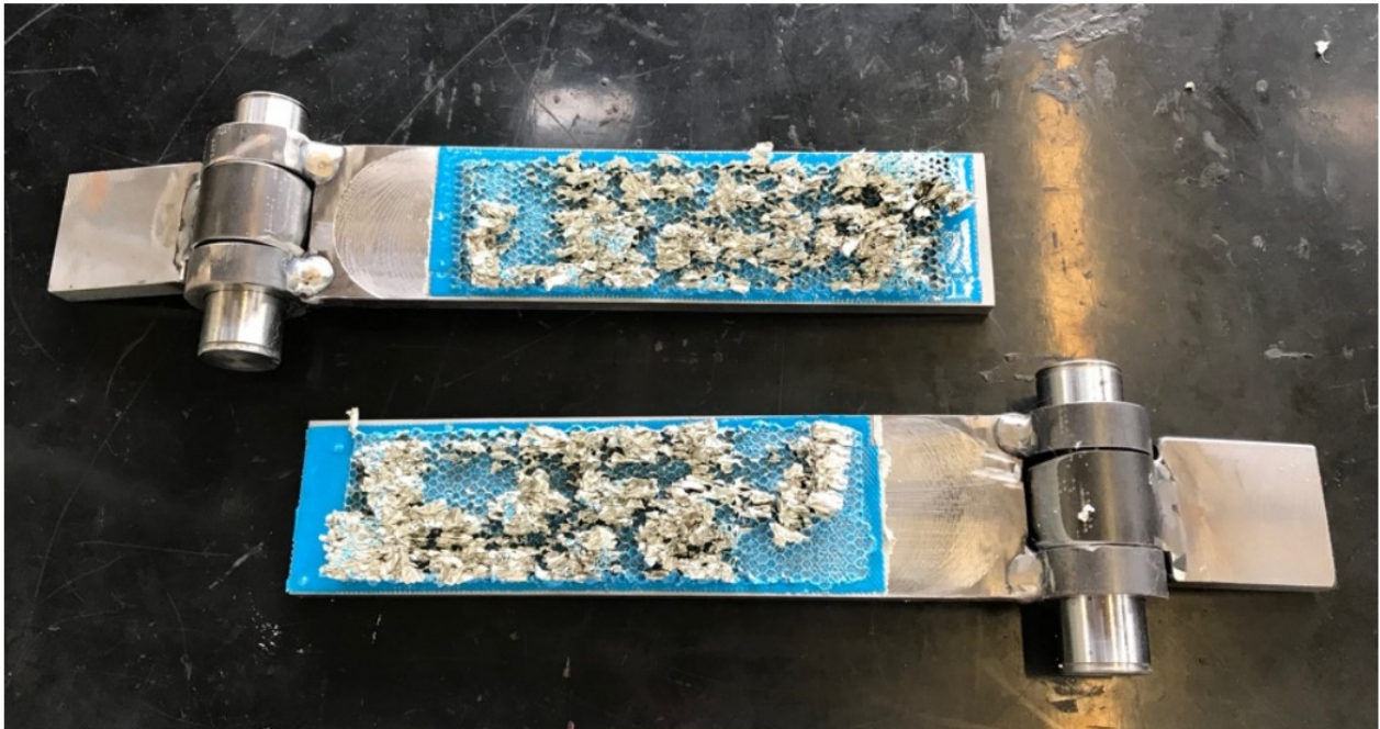
Figura 3.14 Provino Honeycomb post-mortem: termine della prova di caratterizzazione. [8]
