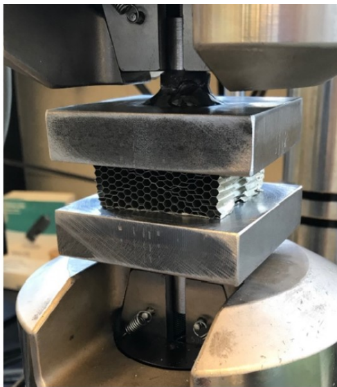
Figura 3.21 Honeycomb prima e dopo la compressione lungo la direzione W. [8]
