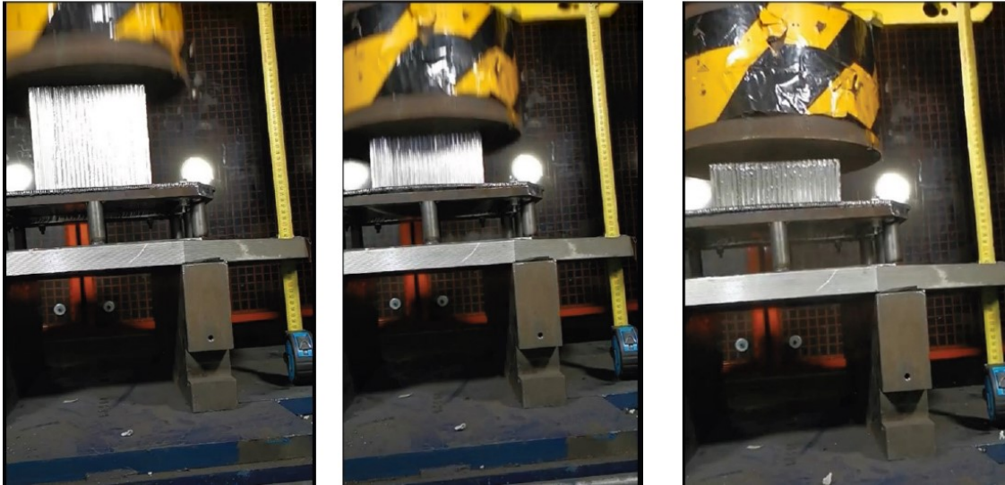
Figura 1.1 Immagini che ritraggono la caduta della massa sull'assorbitore realizzato in Honeycomb della stagione 2019-2020.
