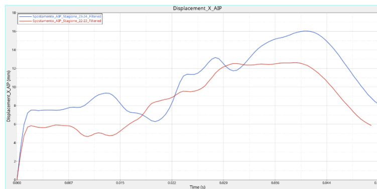
Figura 5.26 Mostra l'andamento dello spostamento e quindi la deformazione del piatto antintrusione nel tempo.
