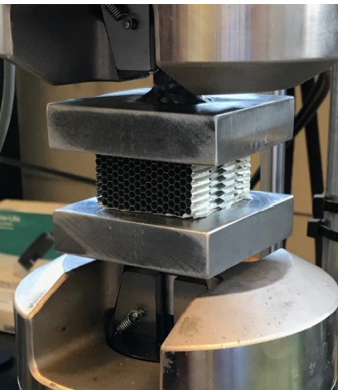
Figura 3.21 Honeycomb prima e dopo la compressione lungo la direzione W. [8]
