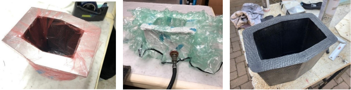
Figura 1.7 Da sinistra verso destra, posizionamento del controstampo, processo di cura ed estrazione finale.
