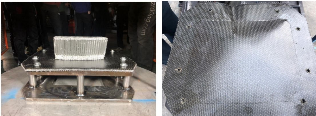
Figura 1.2 Impact attenuator post crush a sinistra e AIP a destra, deformato plasticamente. Stagione 2019-2020.
