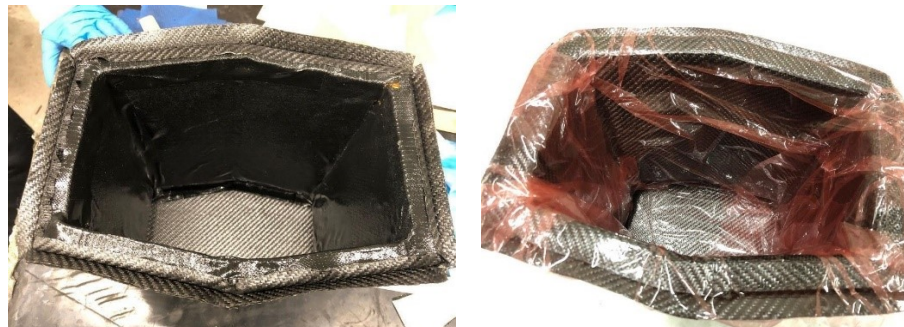
Figura 1.6 Applicazione secondo film di adesivo e seconda laminazione effettuata.
