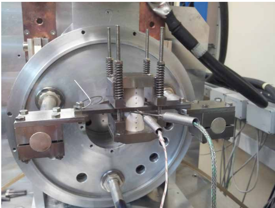
Fig. 4.23: Vista di dettaglio del sistema rappresentato in figura 4.22. In evidenza due termocoppie (tipo C e tipo K) e le sedi realizzate sui materiali per il loro inserimento.
