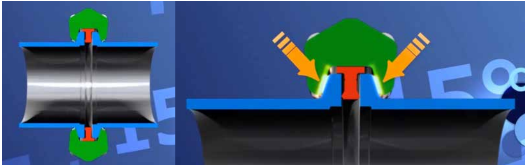
Fig. 3.24: Principio di funzionamento di una connessione mediante morsetto a catena ( chain clamp ).
