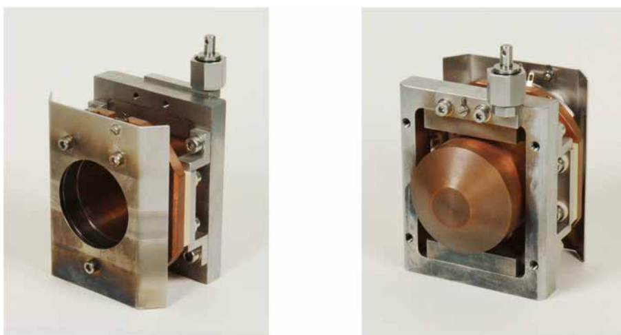
Fig. 2.4: Foto della parte anteriore e posteriore di una Faraday Cup non raffreddata per fascio di 50 mm di diametro, con sistema di soppressione elettro-magnetico [19].
