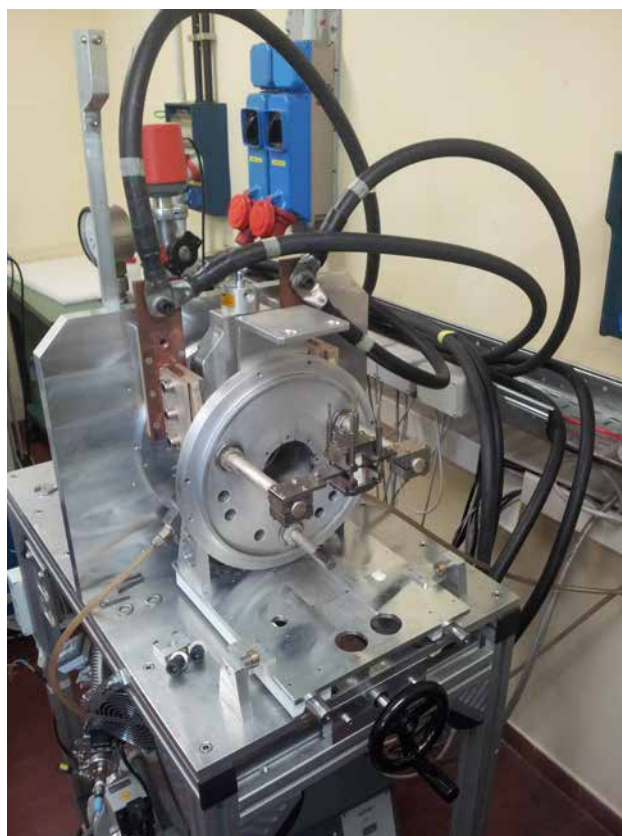
Fig. 4.22: Rappresentazione dell'apparato sperimentale completo di sistema per la valutazione della resistenza termica di contatto tra due materiali.
