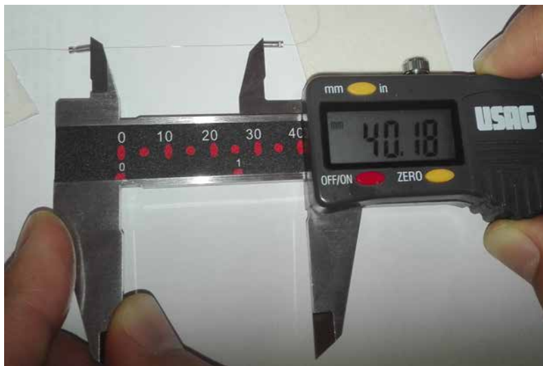
Fig. 5.28: Misurazione mediante calibro della distanza tra i cursori a fissaggio avvenuto. A fronte di una distanza prevista di 40 mm, quella effettivamente ottenuta differisce di meno di due decimi di millimetro.
