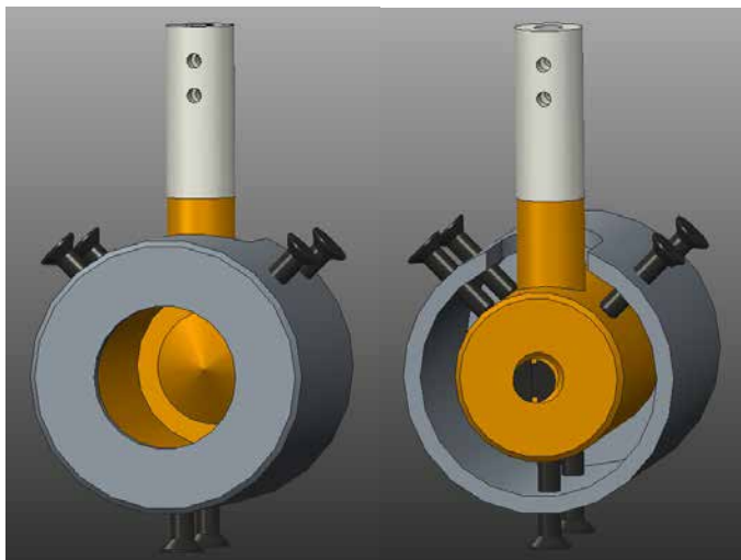
Fig. 2.29: Modelli 3D della Faraday Cup esistente. Il corpo principale della tazza, realizzato in rame, è completamente avvolto da un soppressore cilindrico in alluminio ed isolato elettricamente dal resto della struttura tramite un isolatore in macor che collega la Faraday Cup allo stelo del sistema di movimentazione. Si può osservare, nell'immagine di sinistra, come la tazza abbia un fondo conico, per limitare la fuoriuscita degli elettroni secondari dalla tazza.
