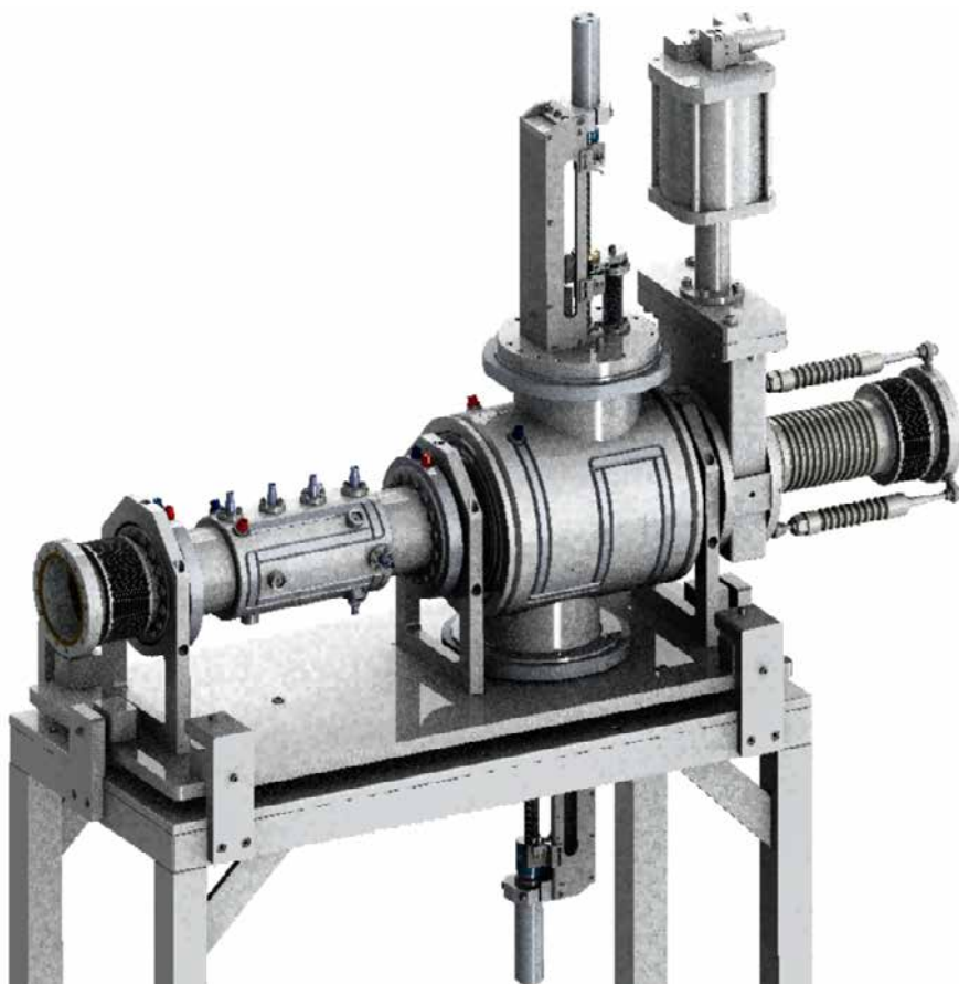
Fig. 5.58: Rappresentazione della parte principale del Front-End protonico del Progetto SPES.
