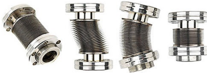
Fig. 3.51: Esempio di soffietto con estremità flangiate. In evidenza i movimenti in direzione assiale, laterale ed angolare che questo componente è in grado di realizzare.
