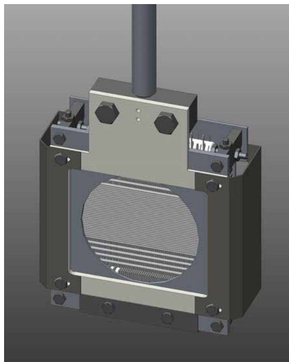
Fig. 3.9: Rappresentazione del Beam Profiler (vista frontale) per la box di diagnostica 1.
