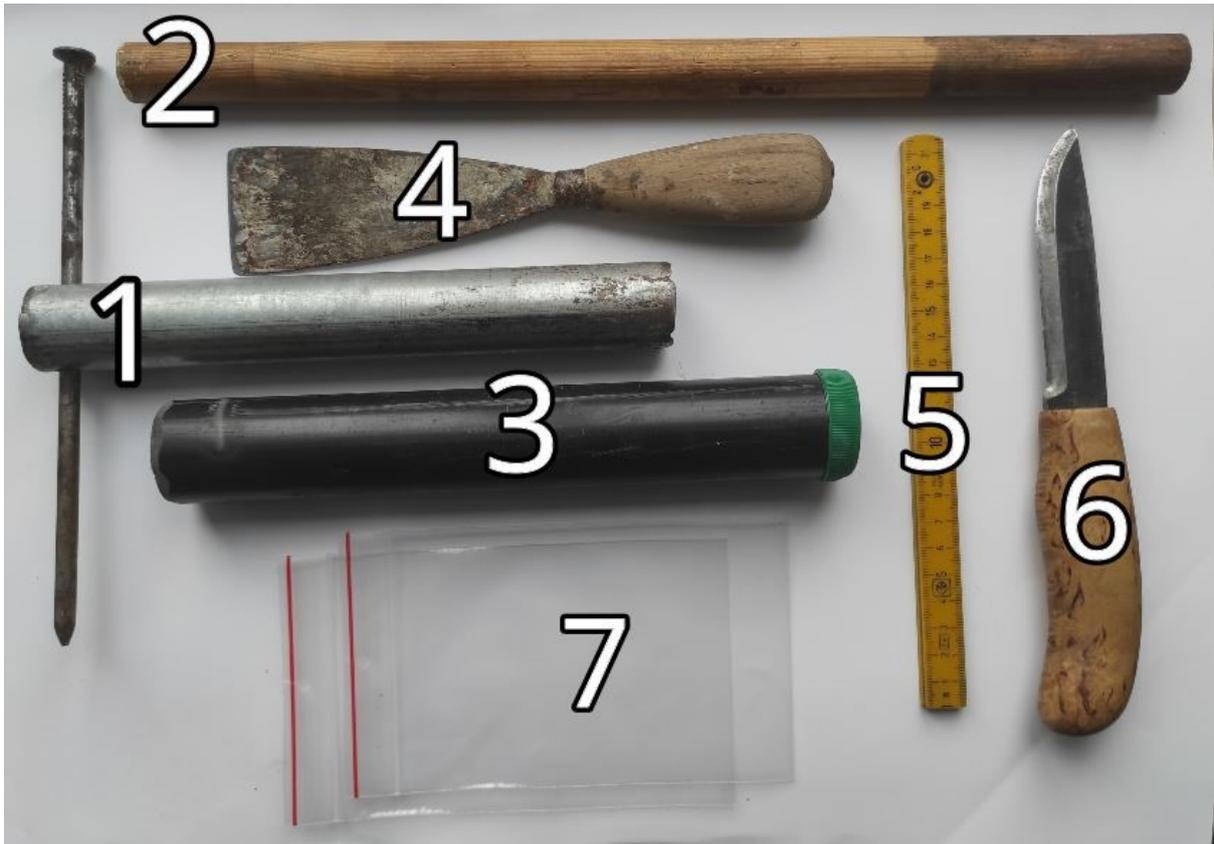
*Figura 9: Alcuni degli strumenti utilizzati per il campionamento: 1 carotatore; 2 cilindro di legno per estrarre il campione dal carotatore; 3 contenitore per il trasporto; 4 paletta per gli scavi; 5 metro; 6 coltello per gli scavi; 7 sacchetti per il trasporto in laboratorio*
