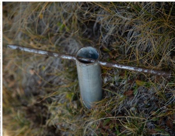
*Figura 13: Esempio di prelievo tramite utilizzo del carotatore*
