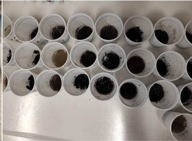
*Figura 19b: Campioni preparati per la misurazione del pH*
