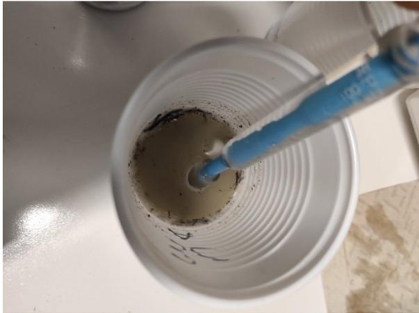
*Figura 19a: Misurazione del pH*
