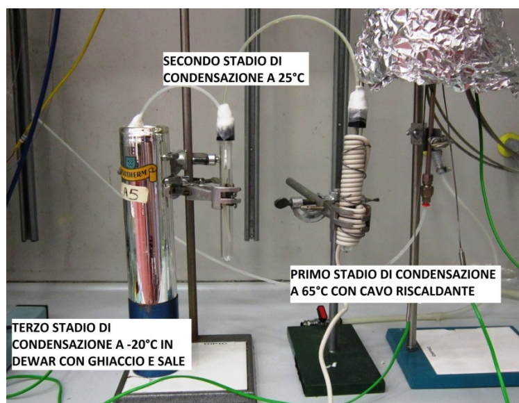
Figura 3.3. Sistema di condensazione a tre stadi
