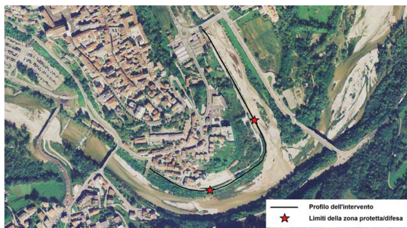
Figura 5.5: Traccia del profilo longitudinale della sponda destra interessata dall'intervento a Belluno.
