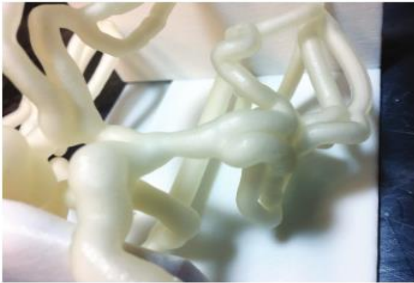
Figura 8- Esempio di occlusione in un modello intracranico stampato in 3D. Da: Agilus30 Improves Performance of Vascular Models. Application customer story: The Jacobs Institute
