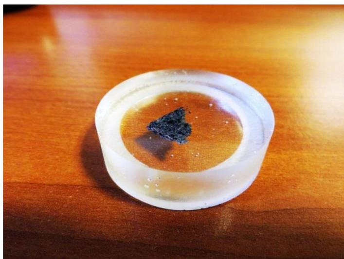
**Figura 20: Campione inglobato in resina epossidica**
