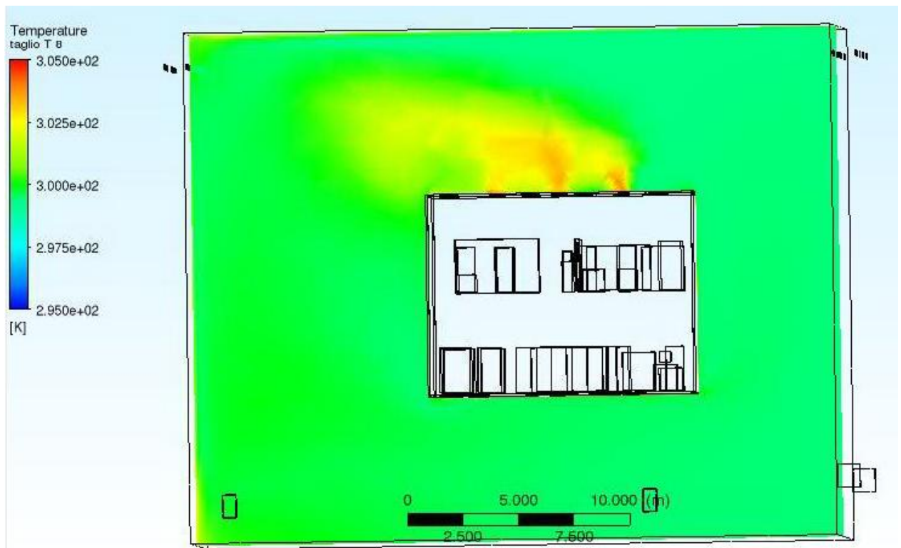
figura 5.3.2.1: taglio temperature aria edificio 8. In giallo vi è l'aria in uscita dal deck
