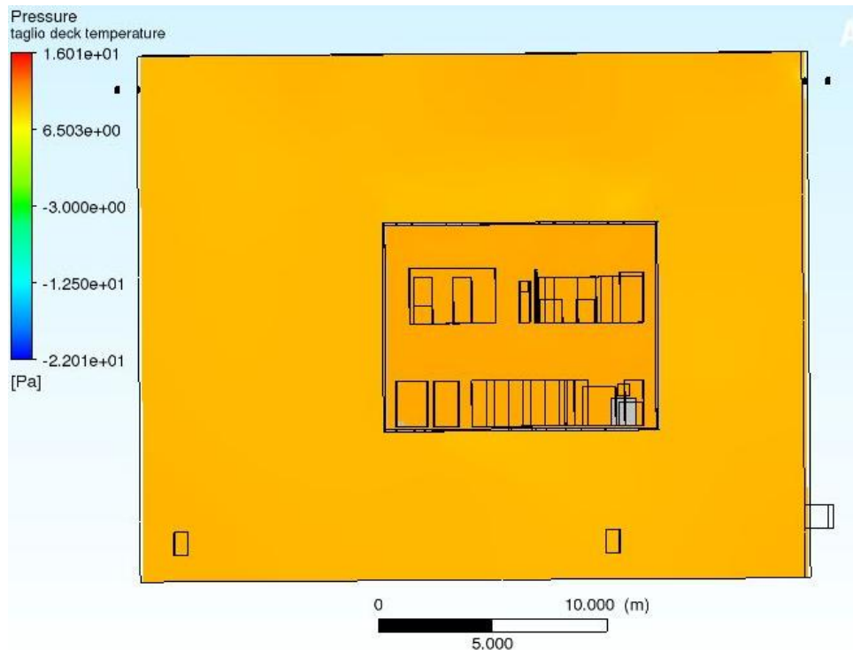
figura 5.1.6.3: variazione della pressione relativa. Il colore uniforme spiega come la pressione vari di valori bassi in zone diverse del dominio fluido.
