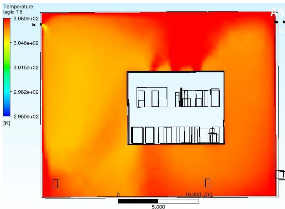
Figura 5.4.12: profilo termico delle temperature esterne al deck
