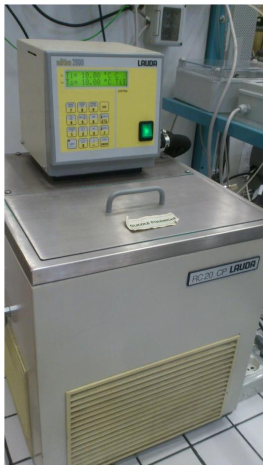
**Figura 3.13.** Chiller LAUDA utilizzato per termostatare il condensatore a 10°C.
