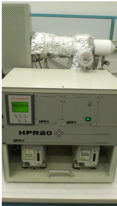
**Figura 3.15.** Spettrometro di massa utilizzato.
