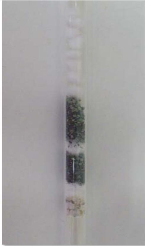
**Figura 3.8.** *Reattore in quarzo. All'interno si può notare la termocoppia che poggia dal basso sul monolita ceramico di supporto, mentre al di sopra il letto catalitico miscelato col SiC è intervallato da strati di lana di roccia. Lo strato superiore serve a migliorare il mixing dei gas.*
