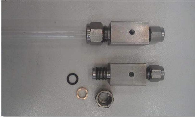
**Figura 3.7.** Raccordi metallici per il reattore in quarzo.
