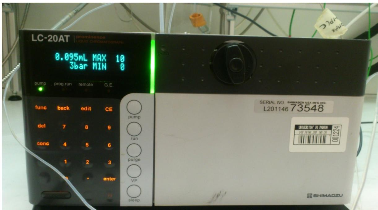
**Figura 3.3.** Visione frontale della pompa. Sulla sinistra si può notare il pannello, mentre al centro vi è la manopola per azionare la linea di scarico. Nel display viene riportata la portata impostata (in figura è pari a 0.095 ml/min), la pressione di esercizio (3 bar) e la pressione massima e minima tollerate.
