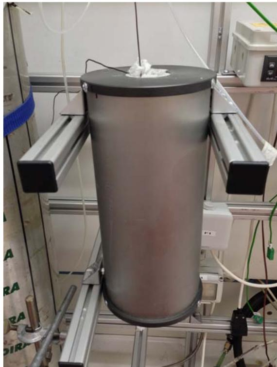
**Figura 3.10.** Forno flangiato col corpo in alluminio, ospitante la resistenza ceramica riscaldante.
