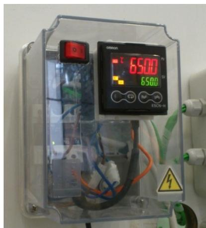
**Figura 3.6.** Controllore di temperatura Omron EC5N-H.
