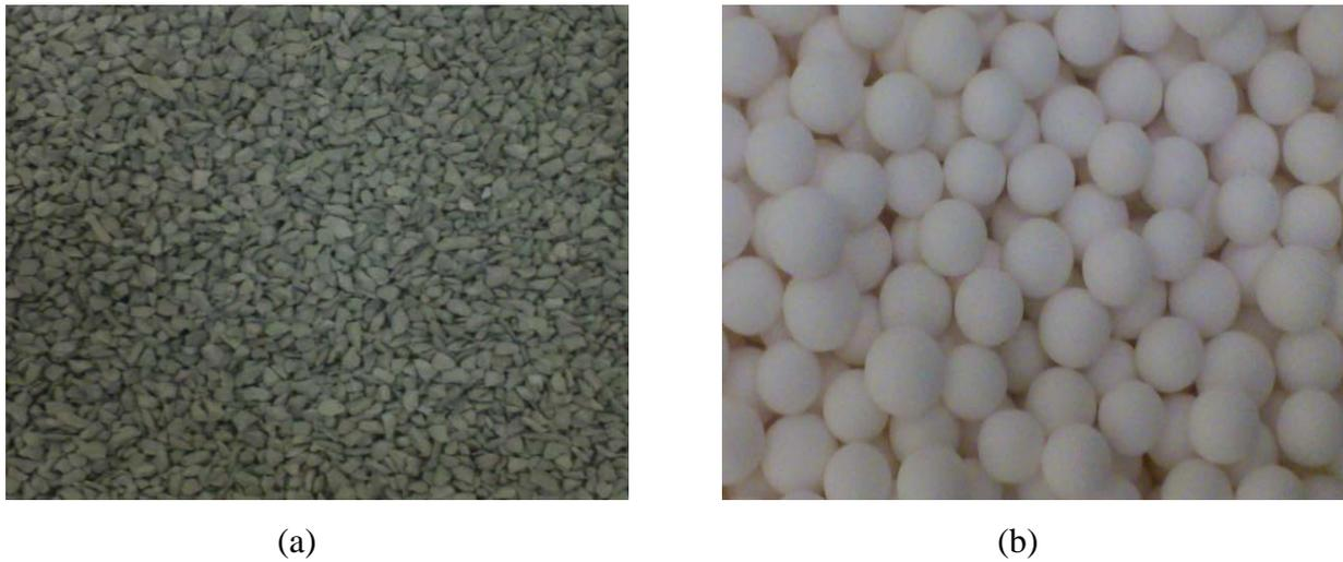
**Figura 3.11.** Catalizzatore adoperato, dimensione 1 mm (a); sferette d'allumina utilizzate, diametro 3 mm (b).
