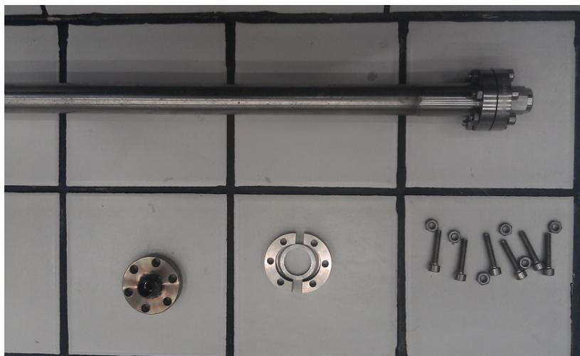
**Figura 3.9.** *Reattore in acciaio con relative flange.*
