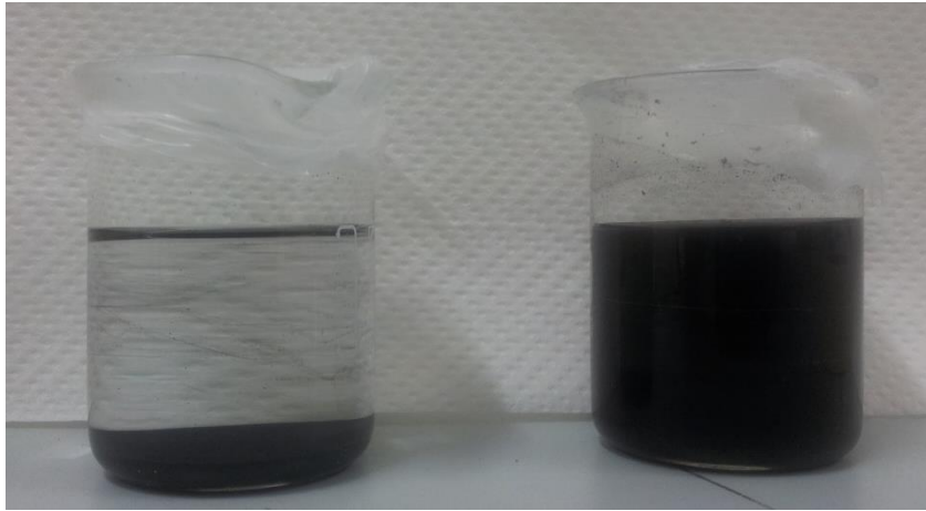
Figura 7.11. Immagine di un campione acquoso (a sinistra) e di un campione in DMF, a parità di sonicazione e tempo di sedimentazione.
