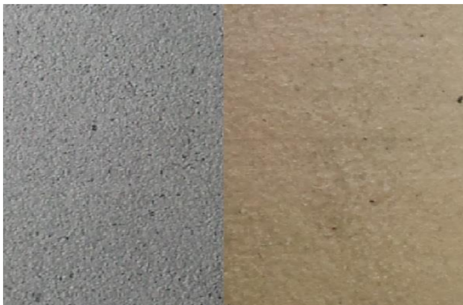
Figura 9.3. Immagine dell'espanso caricato con "Graphene Avanzare" (a sinistra) e dell'espanso caricato con "Grafene_MW"
