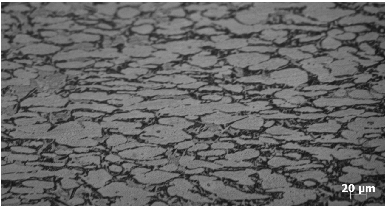
Figura 44: micrografia a 200 ingrandimenti del provino trattato per 35' a 850°C. Nonostante non sia stato svolto alcun attacco metallografico la maglia dei grani è comunque ben definita. Non è tuttavia possibile riconoscere la presenza delle fasi secondarie
