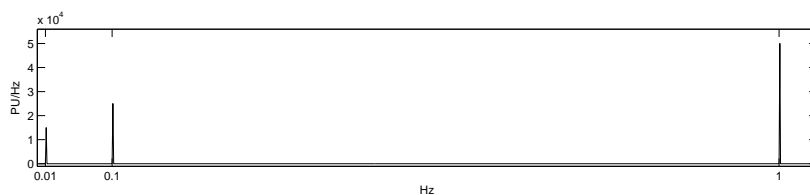
Figura 3.2. Spettro del segnale di Fig.3.1, ottenuto tramite la FT.
