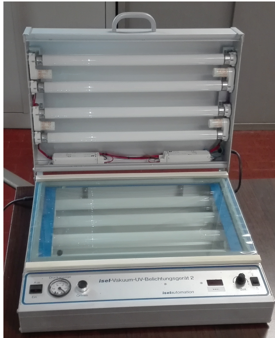
Fig. 4.24: Bromografo utilizzato per il trattamento della scheda.
