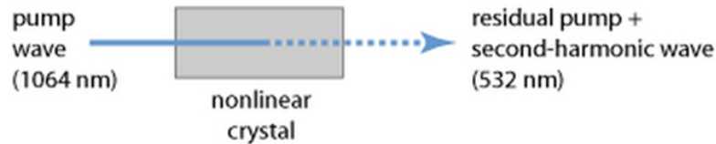
Fig. 3.12: Effetto di un cristallo non lineare su un raggio laser.
