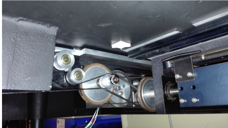
Fig. 5.5: Ingranaggi di collegamento tra motore e reticolo nel Monocromatore.
