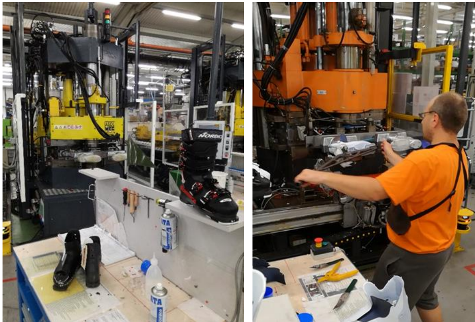
Fig. 1.3.1.3 Macchinario di stampaggio a iniezione monocolore con modello di riferimento (a sinistra)
