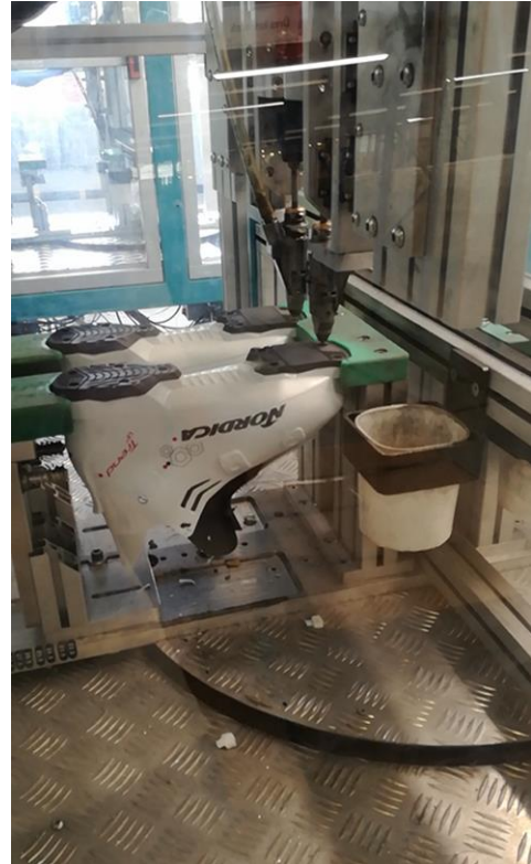
Fig. 1.3.1.5 Un tampone in azione su un modello Nordica (a sinistra)
