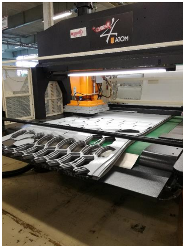
Fig. 1.3.1.2 Una fustellatrice automatica in azione
