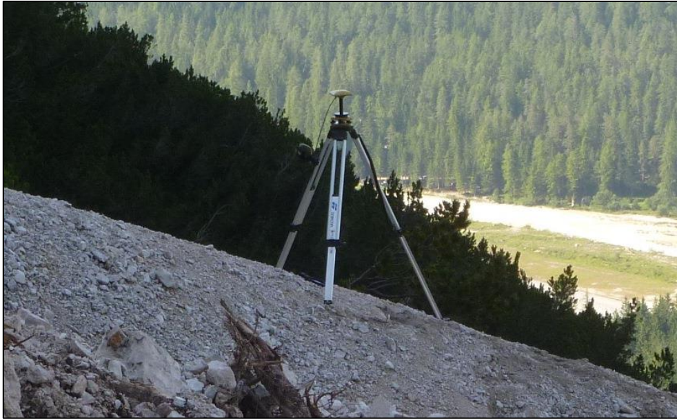
Fig. 4.14: Ricevitore Topcon "GRS-1" con antenna GNSS "PGA-1"
