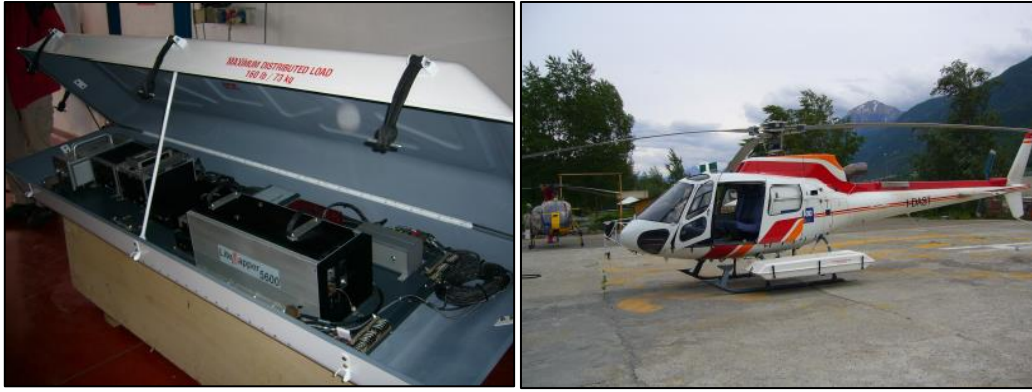
Fig. 4.8 Esempio di laser scanner da elicottero
