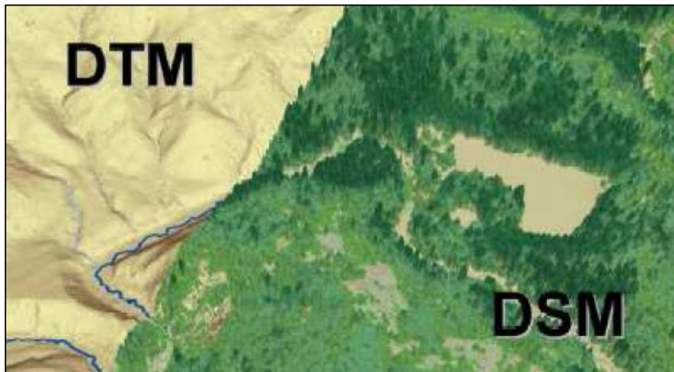
Fig. 5.1: Superficie considerata in un DSM contro superficie considerata in un DTM.
