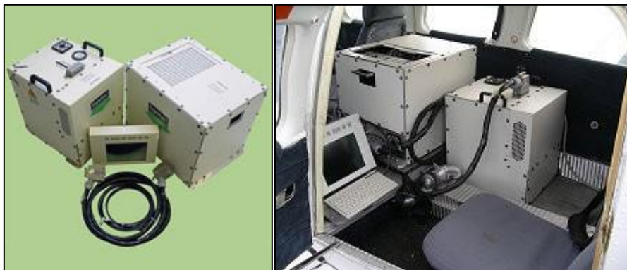
Fig. 4.7: Esempio di laser scanner da aereo
