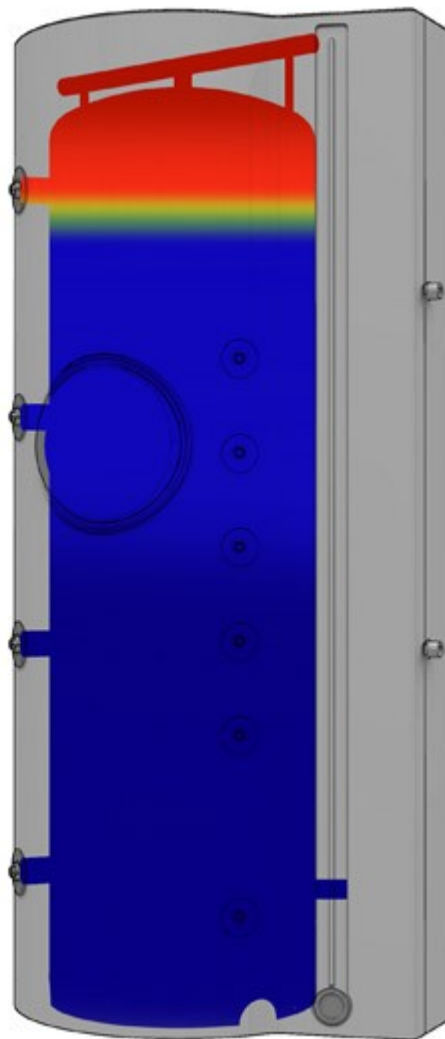
Illustrazione 28: Esempio di accumulo termico ad acqua con stratificazione
