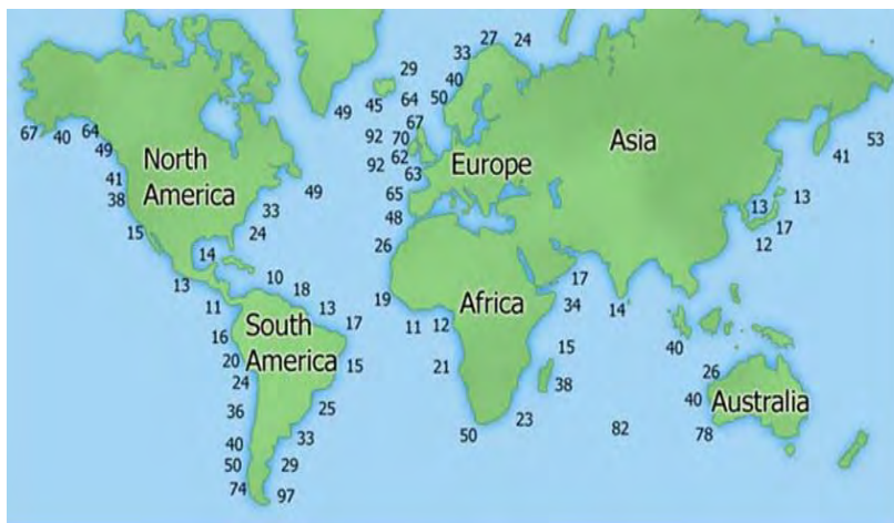
Fig. 2.1 – Distribuzione mondiale della potenza delle onde marine in mare aperto per unità di larghezza del fronte d'onda (in kW/m)
