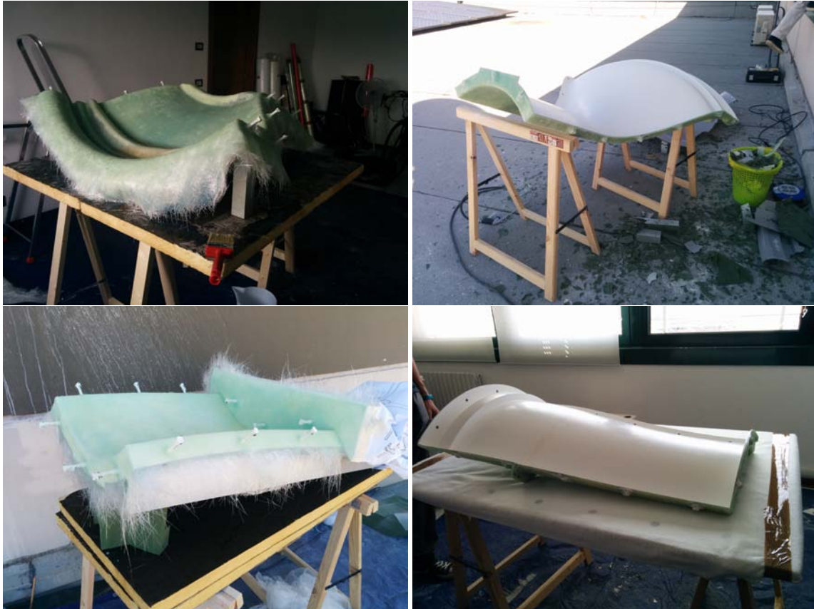
Figura 4.2. Realizzazione e rifinitura degli stampi in vetroresina.
