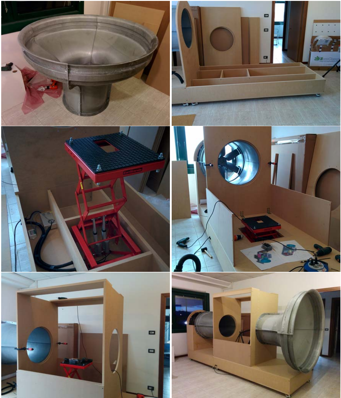
Figura 4.8. Assemblaggio della metà anteriore della galleria del vento.
