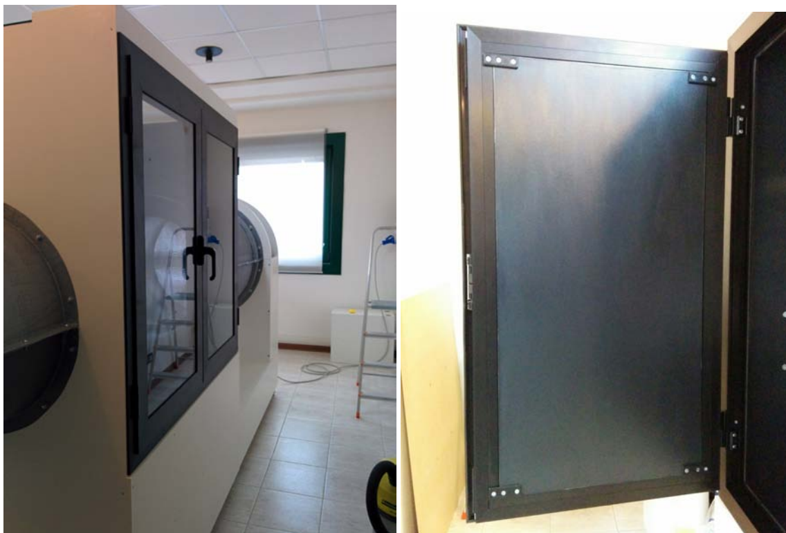
Figura 4.11. Finestra per l'inserimento e la rimozione dei provini da testare.
