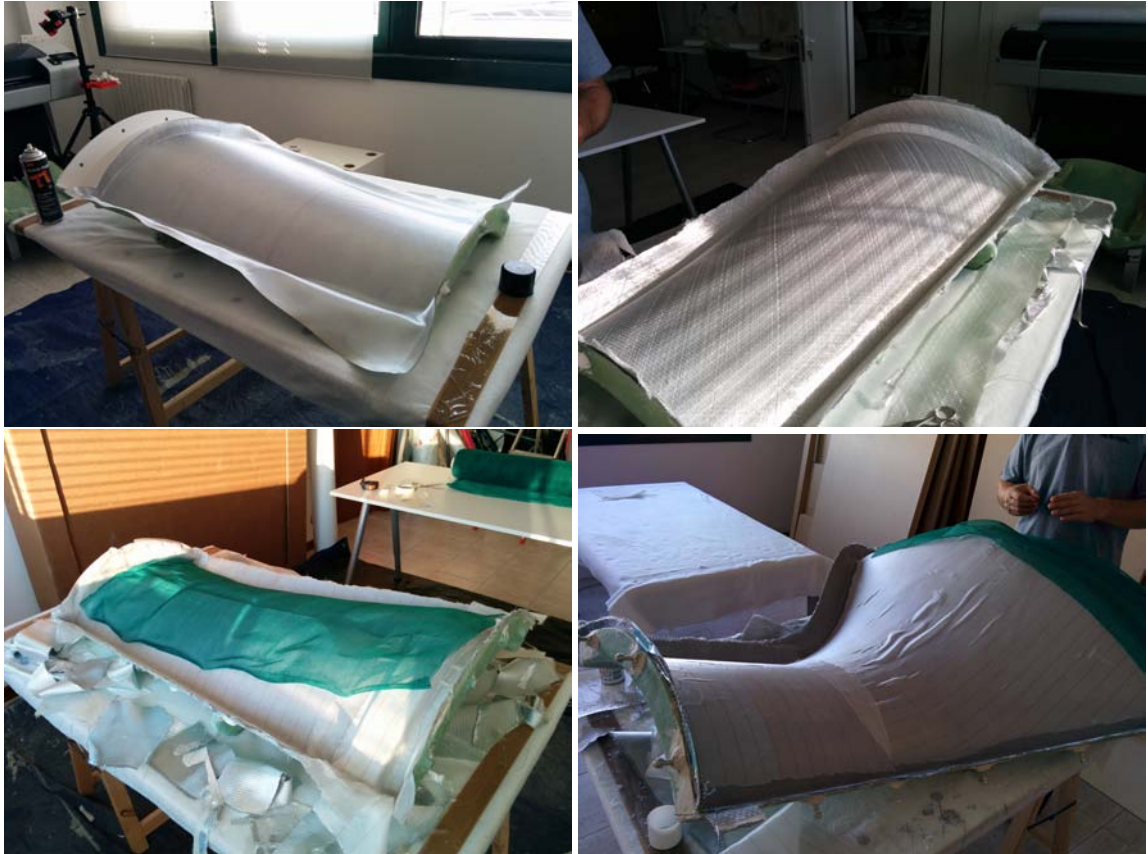
Figura 4.3. Preparazione degli stampi per l'infusione a vuoto.
