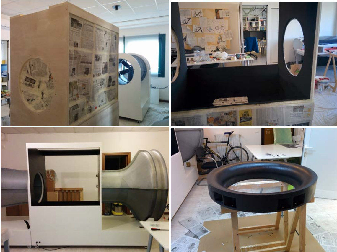
Figura 4.9. Verniciatura della galleria.
