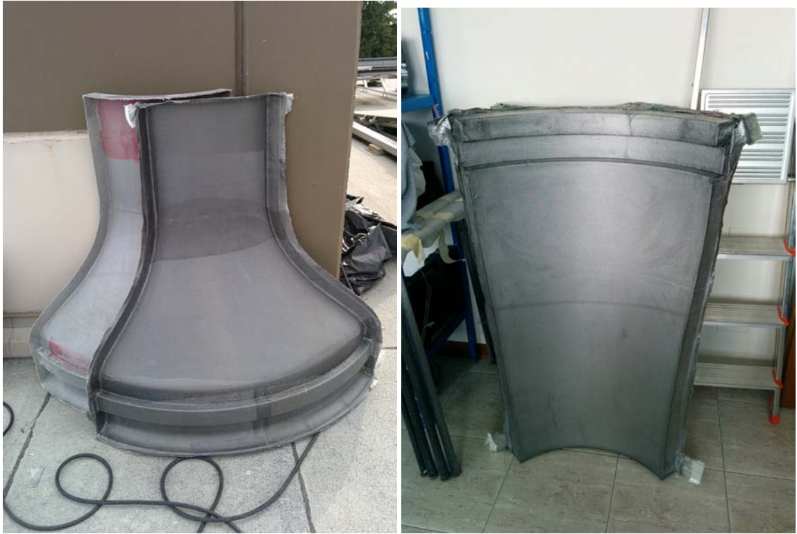
Figura 4.5. Quarti del convergente e del divergente usciti dai sacchi da vuoto dopo l'infusione.
