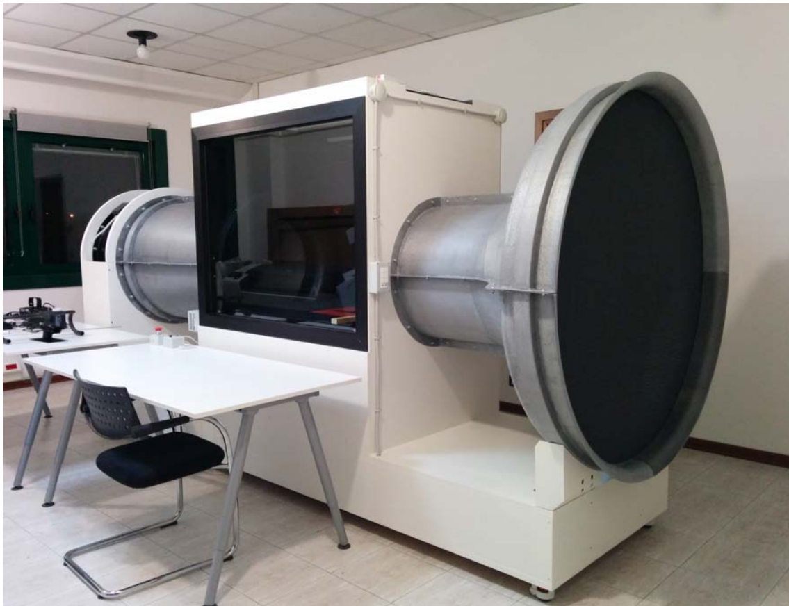
Figura 6.1. La galleria del vento ultimata.
