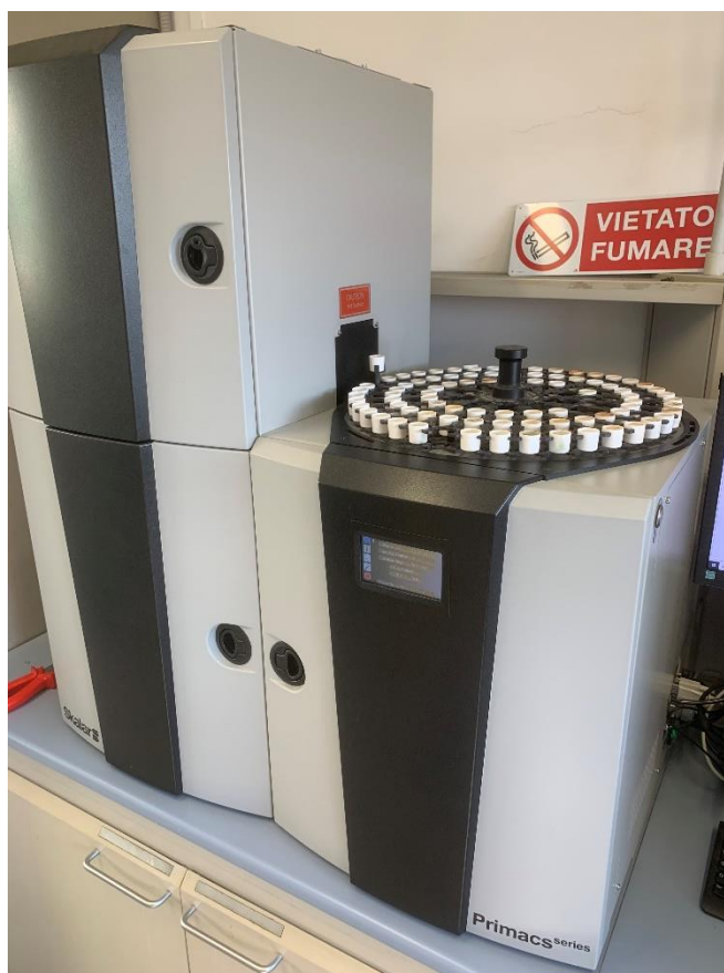
Figura 8. Skalar Primacs SNC-100 che ha fornito i dati sul carbonio inorganico e organico
