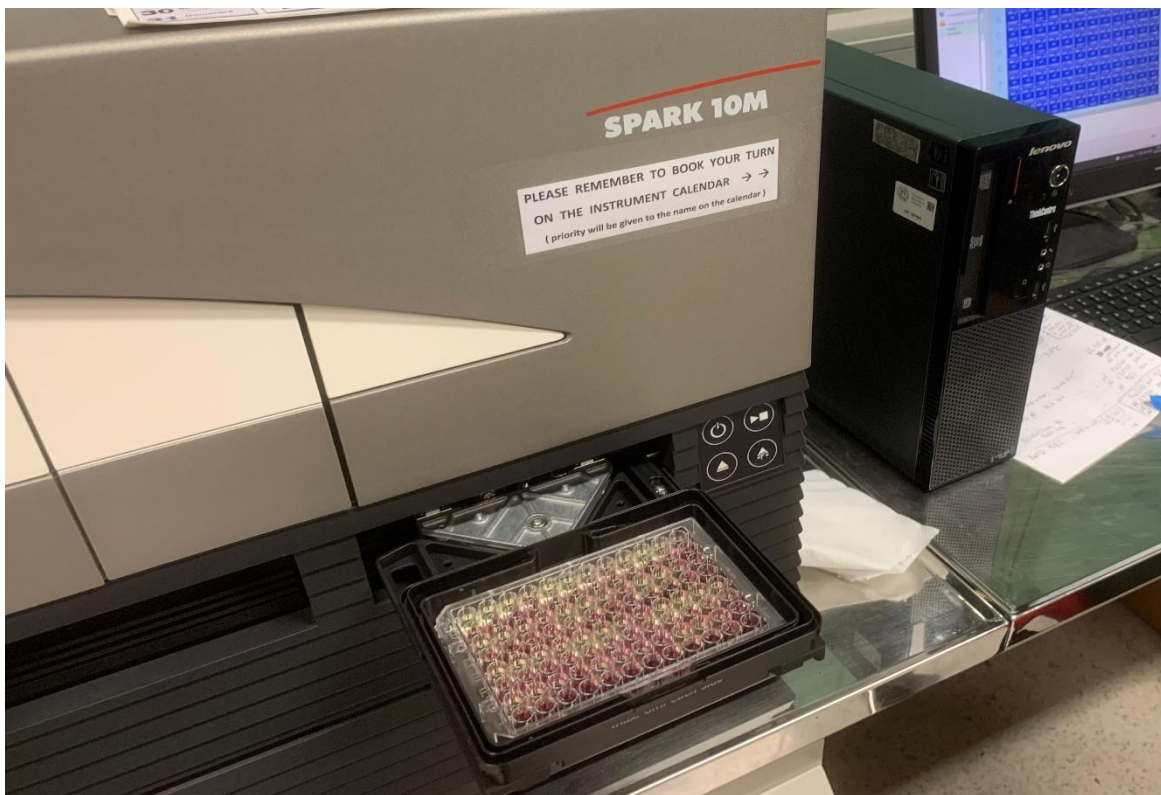
Figura 13. Tecan Spark 10M. lo strumento che ha effettuato tutte le letture della nuova metodica
