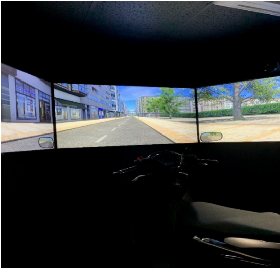
Figura 8. Vista dell'ambiente virtuale attraverso i tre schermi del simulatore LANDER
