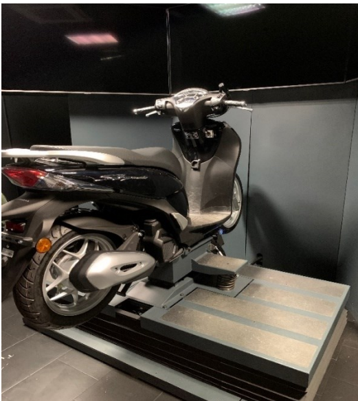
Figura 7. Gli elementi essenziali del simulatore LANDER: ciclomotore, pedana mobile e schermi.
