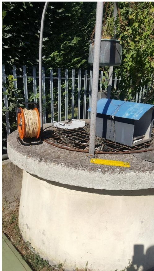
FIG. 25: Pozzo misurato durante la campagna freaticometrica, con gli strumenti di lavoro utilizzati: freaticometro e metro.
