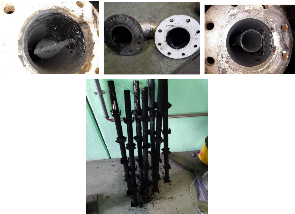
Figura 4.12: grado di sporramento scambiatore e asta per aumento turbolenza
