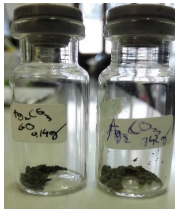
Figura 4.10 Polveri di \text{Ag}_2\text{CO}_3\text{-GO} e \text{Ag}_2\text{CO}_3
