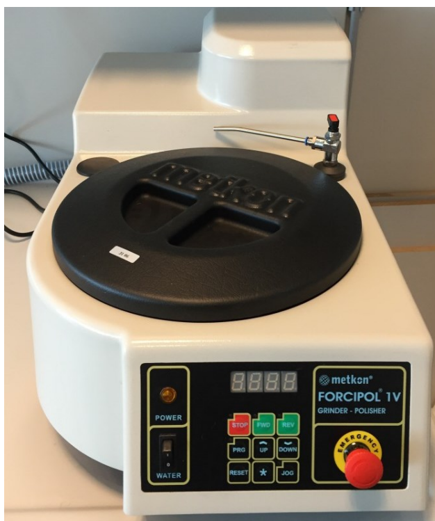
Figura 6.2: Lucidatrice Forcipol 1v utilizzata per la rimozione dei precedenti rivestimenti, e successiva lucidatura.
