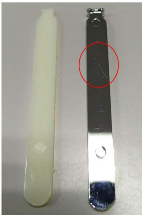
Figura 30.2: A sinistra, un provino in ABS, non mordenzato. A destra, un provino cromato, con la croce del test di adesione evidenziata dal cerchio rosso.
