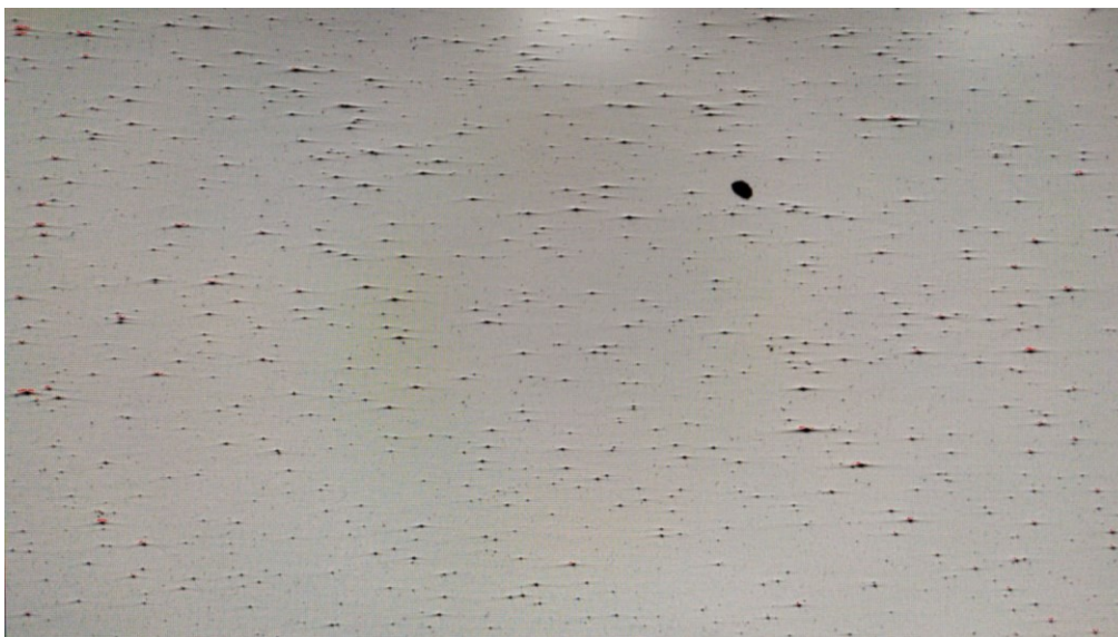
Figura 10.2: Tipico difetto di "comet tails": si nota una linea vicino ai fori lasciati dalle particelle sospese.
