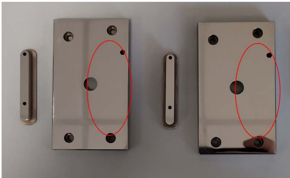
Figura 8.2: Inserti lucidati. In rosso la zona di maggiore interesse, da lucidare con cura.
