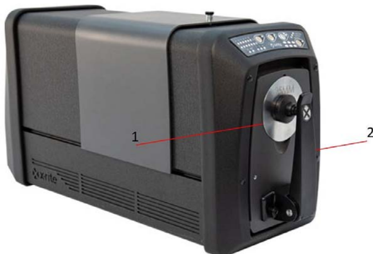
Figura 24.2: Spettrofotometro da banco X-Rite utilizzato per le misure di colore.
