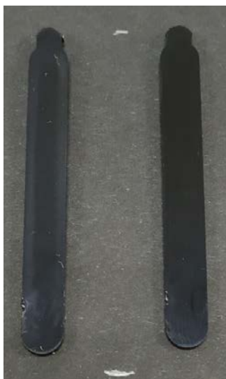
Figura 3.3: Differenza tra provino da stampo DLC (a sinistra), e provino da stampo convenzionale.
