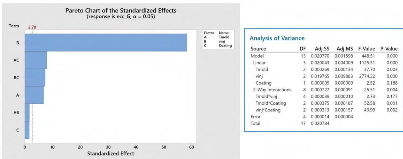
Figura 50.3: Diagramma di Pareto ed analisi della varianza per l'eccentricità dei siti grandi.
