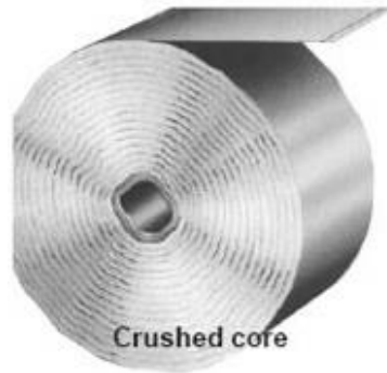
Figura 3.1 Anima schiacciata (crushed core) [3]
