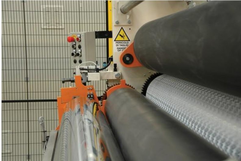
Figura 2.6 Dettaglio rulli per goffratura HELIO
