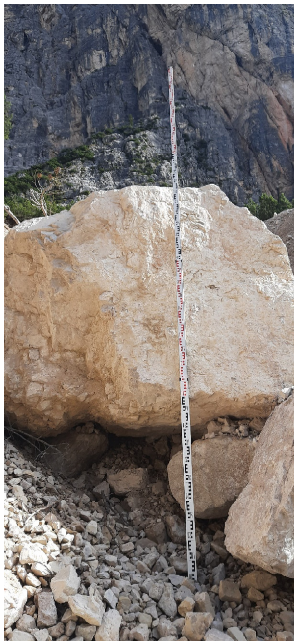
foto n.26 – Particolare del masso rinvenuto nel canale C18 ad una quota di circa 35m più in alto rispetto alla pista ciclabile, di forma approssimata ad un cubo, con dimensioni di circa 1,90m x 2,00m x 1,90m, volume stimato 7,2 mc, peso stimato 20 tonnellate. (foto dell'autore).
