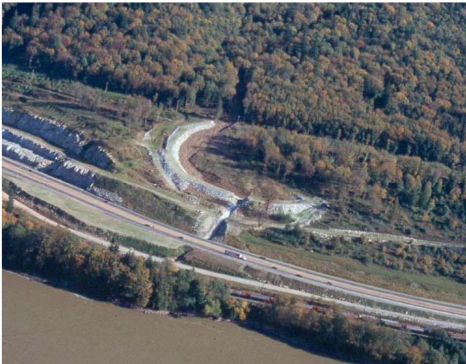
foto n.11 – Bacino di trattenuta aperto a Cheam View nei pressi di Chilliwack nella Columbia Britannica, Canada.
