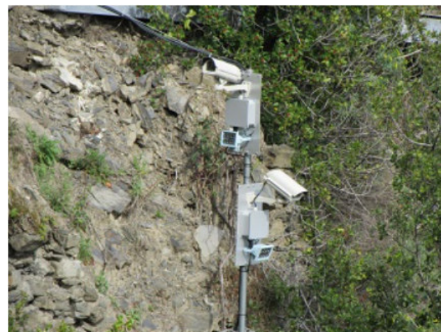
foto n.20 – Esempio di stazione di monitoraggio video equipaggiata con videocamere a visione notturna. (fonte: www.geoprodotti.eu )
