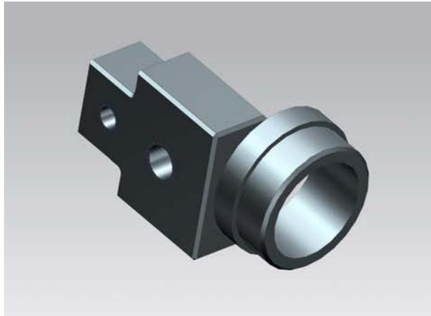
**Figura 3.21.** Si salda l'anello al corpo a forma di parallelepipedo
