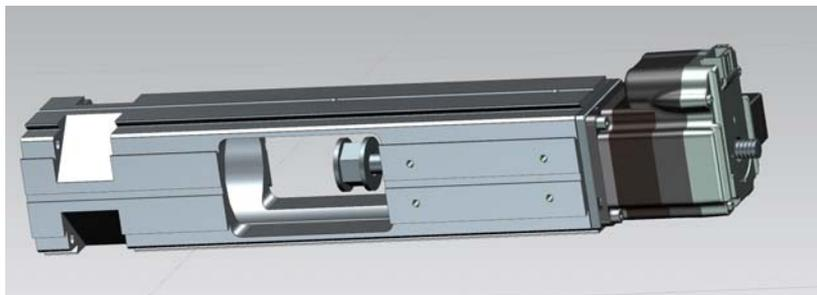
**Figura 3.27.** Si monta il motore, sul profilato Montech.
