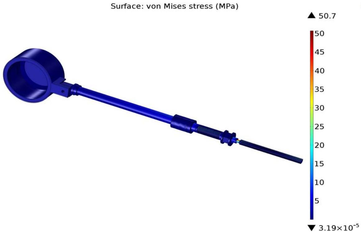
**Figura 5.8.** Distribuzione delle tensioni con sensore in posizione di misura. La tensione massima è presente sull'estremità filettata della vite del motore.
