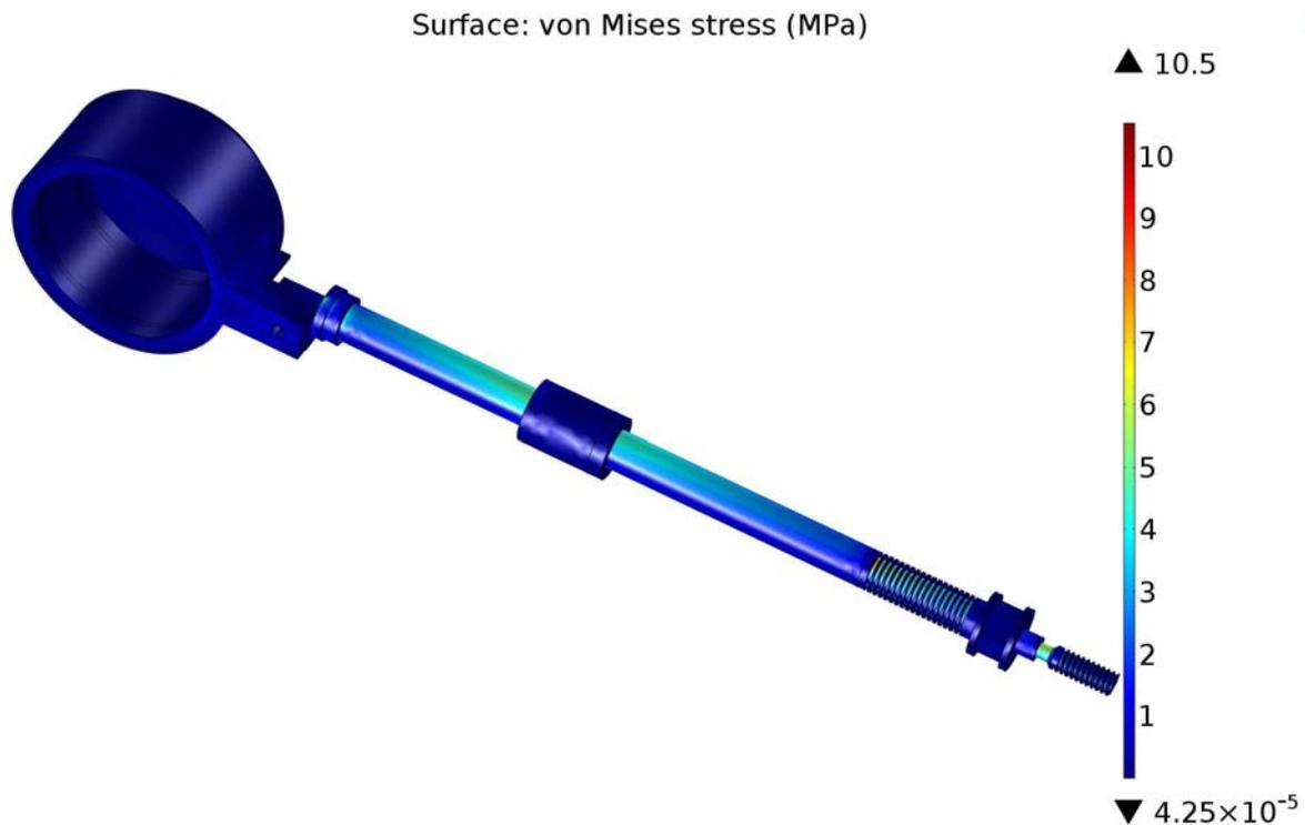
**Figura 5.11.** Distribuzione delle tensioni con sensore in posizione di riposo. La tensione massima è ancora una volta presente sull'estremità della vite del motore.
