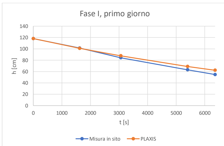
Figura 7.6.1: Terreno omogeneo con permeabilità quadruplicate durante la fase I
