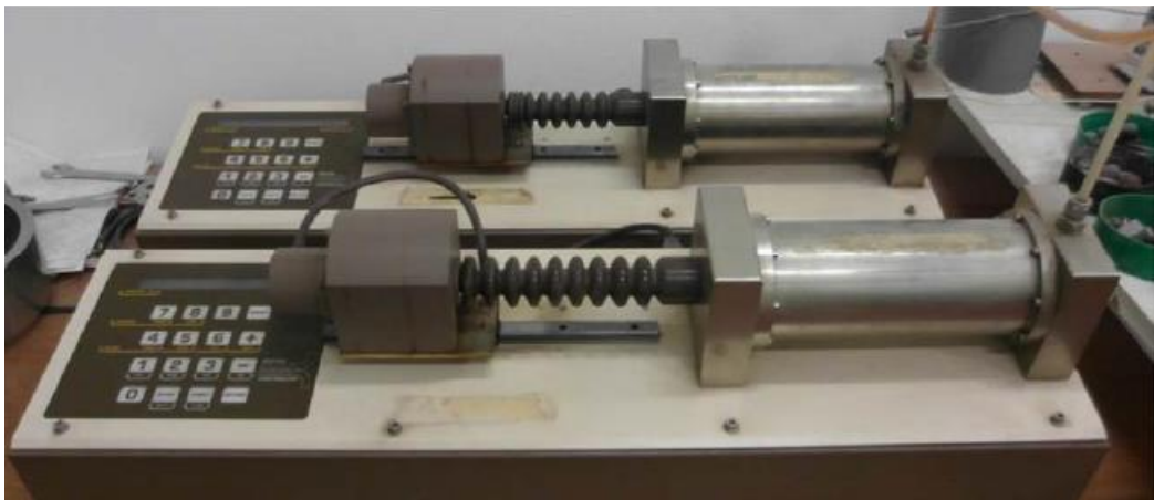
Figura 3.1.1.2: Pompe di flusso utilizzate in laboratorio
