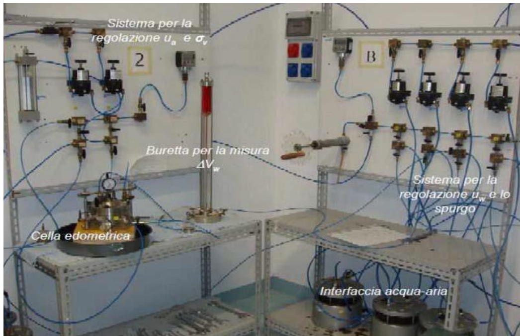
Figura 5.4.1: Edometro a suzione controllata
