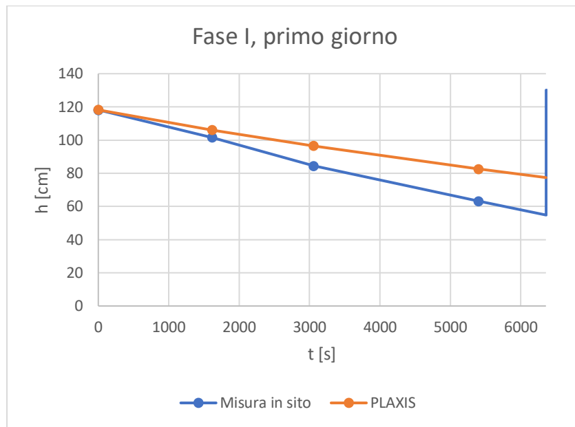
Figura 7.6.3: Terreno omogeneo con permeabilità amplificata di 2,5 volte durante la fase I
