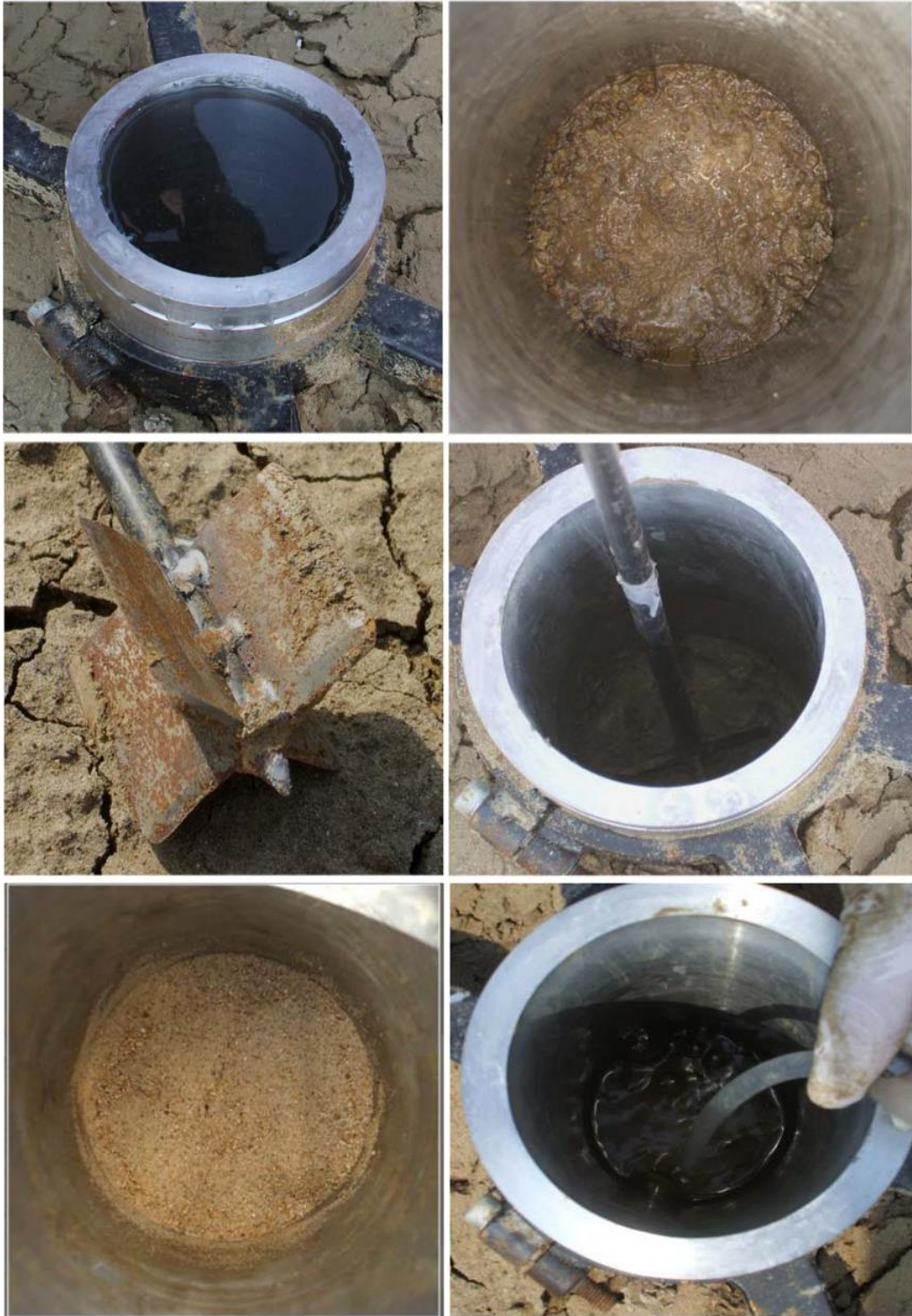
Figura 4.2.4: Rimozione dell'apparato superiore, svuotamento dell'acqua, approfondimento del foro, riempimento con sabbia tarata poi con acqua
