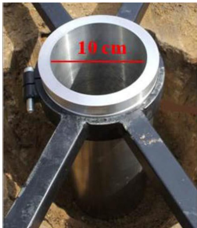
Figura 4.1.2: Posa in opera del casing sul foro
