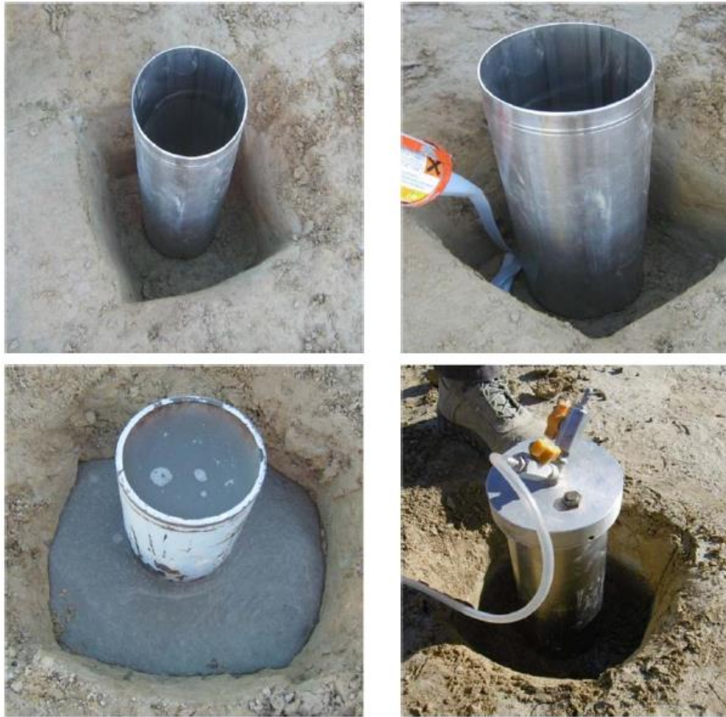
Figura 4.2.2: Inserimento, sigillatura, riempimento e chiusura del casing
