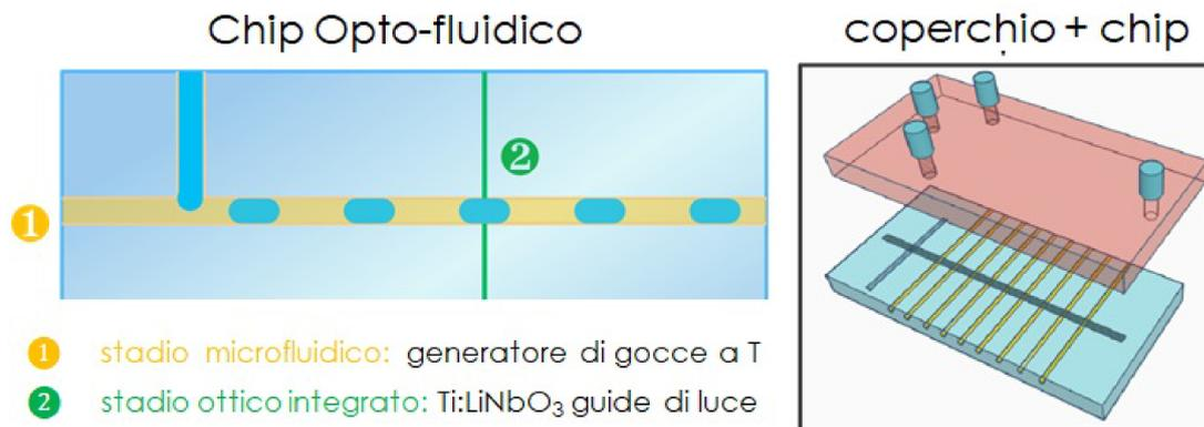
Figura 2.3: Schema di un *chip*
