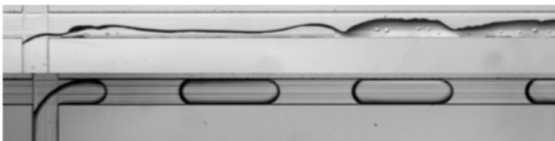
Figura 2.6: Comportamento della soluzione acquosa in caso di canale non funzionalizzato (sopra) e funzionalizzato (sotto)
