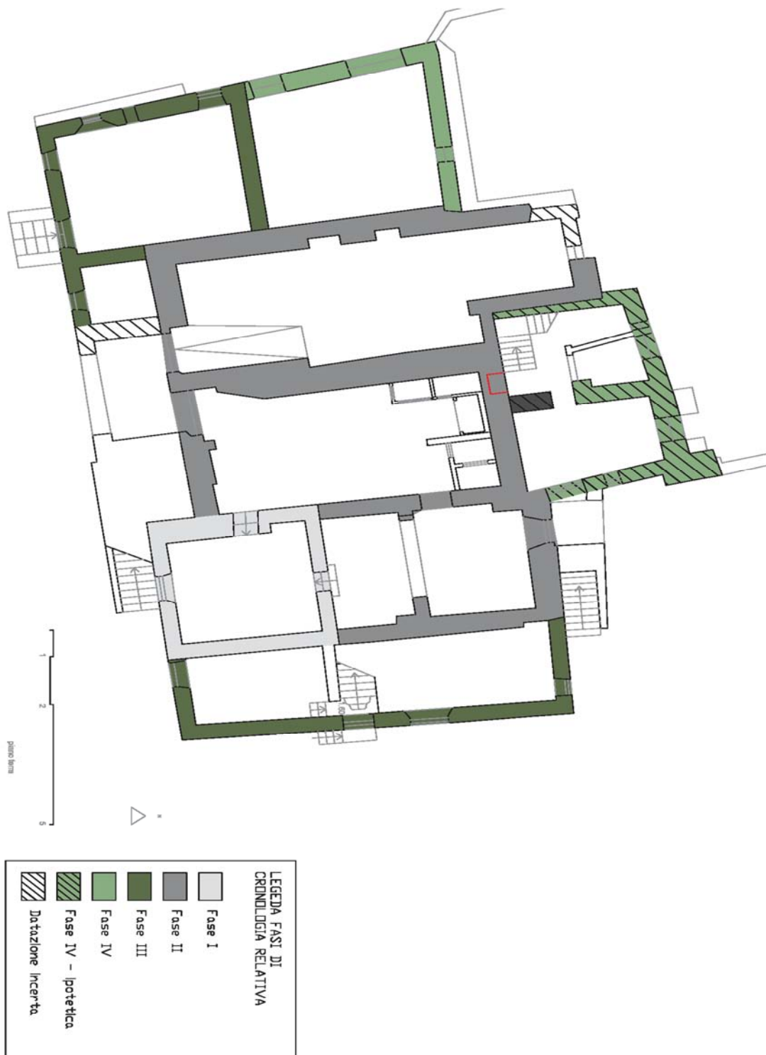
Fig. 4.23 Individuazione delle Fasi costruttive dell'aggregato
