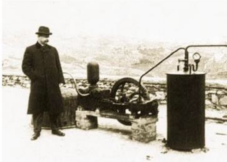
Figura 1 - Larderello 1904. La prima macchina (un motore alternativo accoppiato ad una dinamo), che ha prodotto elettricità sfruttando il vapore geotermico. A fianco, il Principe Piero Ginori Conti
