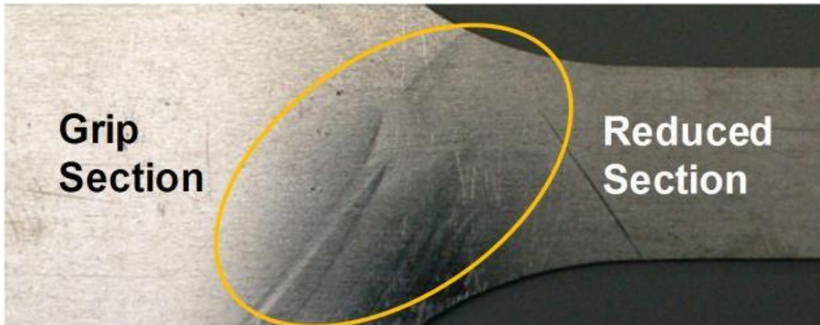
Figura 3: Marcata formazione di Bande di Luders durante una prova di trazione su un acciaio AISI 430
