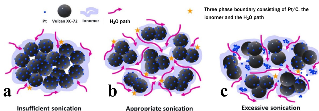
Figura 16 – Illustrazione della dispersione del catalizzatore durante la preparazione dell'inchiostro.
