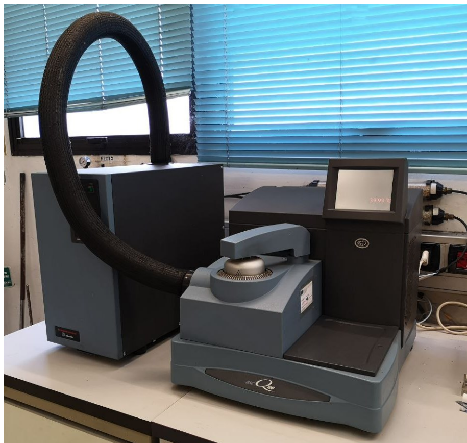
Figura 5-5: Calorimetro a scansione differenziale modulata, TA Instruments mod. Q200.
