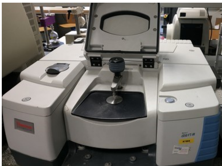
Figura 5-4: Spettrofotometro IR Nicolet IS50 Thermoscientific .
