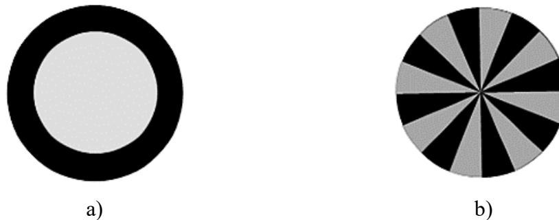
Figura 1-2: Rappresentazione schematica della sezione di una fibra bicomponente di tipo a) sheath-core e b) splittabile .
