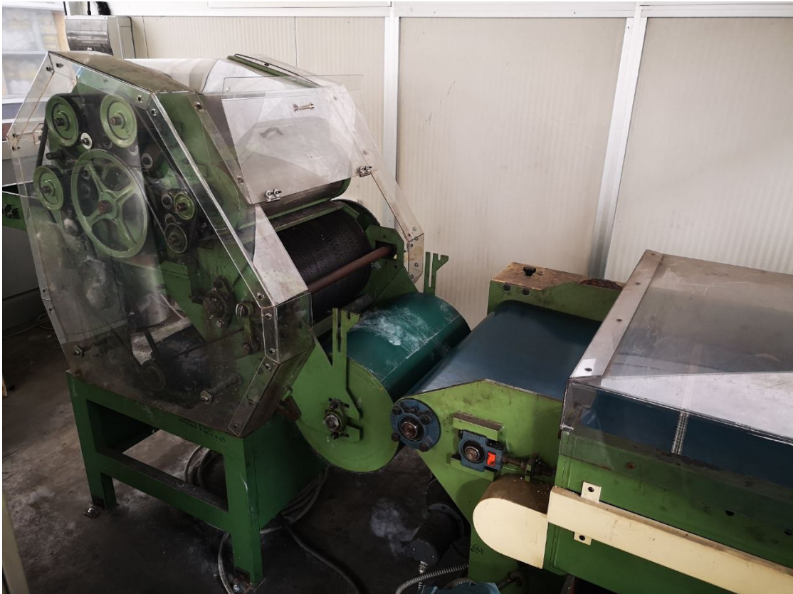
Figura 5-11: Impianto pilota utilizzato per cardare e faldare piccoli quantitativi di fibra.
