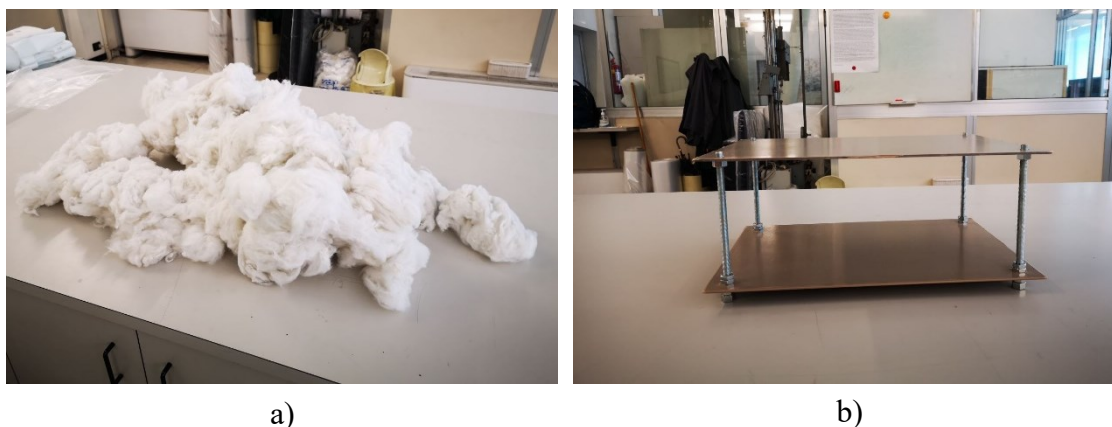
Figura 6-3: a) Miscela di fibre utilizzata prima della cardatura. b) Strumento per controllare lo spessore del provino.
