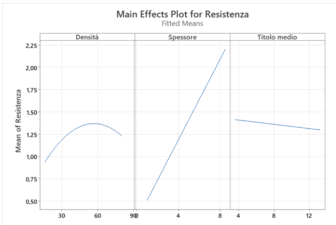
Figura 6-29: Effetto dei fattori singoli sulla variabile risposta resistenza termica ( m^2K/W ). Densità ( kg/m^3 ), spessore (cm) e titolo medio (dtex).
