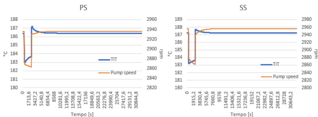
**Figura 5.43:** Andamento di temperatura in ingresso in turbina e velocità di rotazione pompa a seguito di un transitorio con risalita del carico anticipata del 75% e controllo del surriscaldamento
