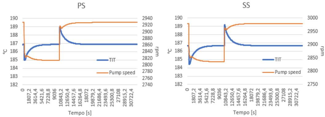
**Figura 5.25:** Andamento di temperatura in ingresso in turbina e velocità di rotazione pompa a seguito di un transitorio con riduzione del 20%
