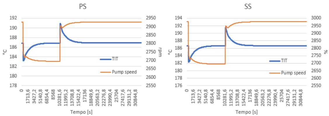
**Figura 5.27:** Andamento di temperatura in ingresso in turbina e velocità di rotazione pompa a seguito di un transitorio con riduzione del 40%
