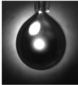
Figura 3.3: Immagine di una pendant drop pronta per l'analisi.
