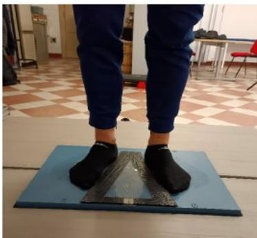
*Figura 2.3: dima per il corretto posizionamento dei piedi per le prove statiche.*
