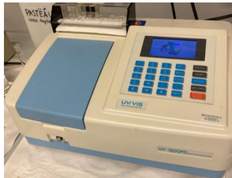
Figura 3.4: Spettrofotometro utilizzato per la lettura dell'assorbanza del dosaggio proteico.
