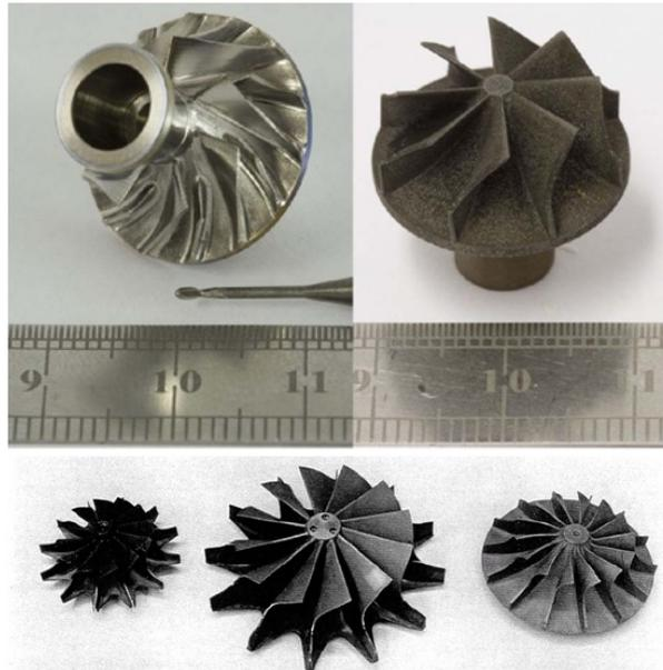
Figura 2.5: Turbine a flusso radiale
