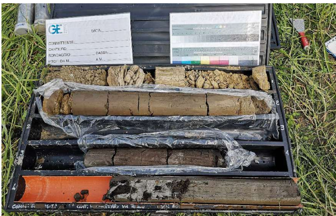
Figura 38 Cassetta catalogatrice della SSDMT2 con all'interno i primi 5 metri.
