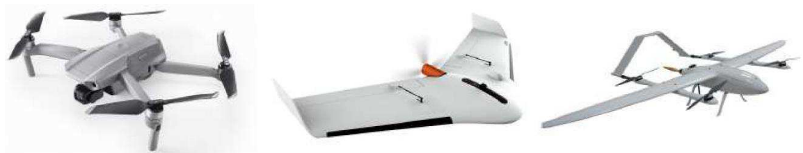
Figure 1.8 Da sinistra verso destra: drone multicottero, drone ad ala fissa e drone VTOL ad ala fissa
