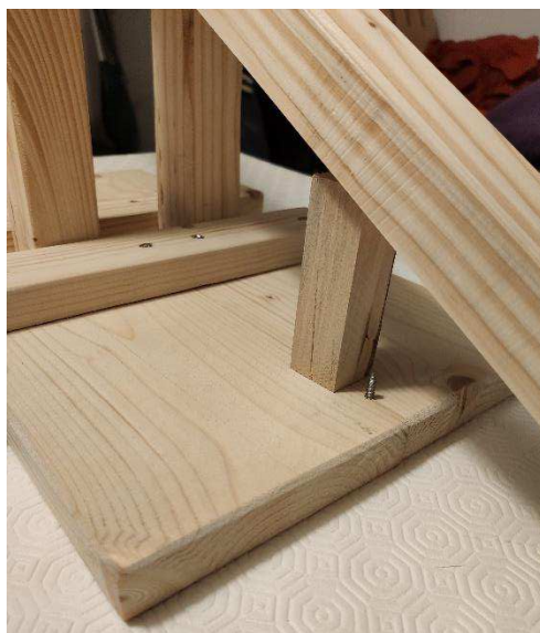
Figure 5.5 Dettaglio del blocchetto per imporre l'angolo massimo
