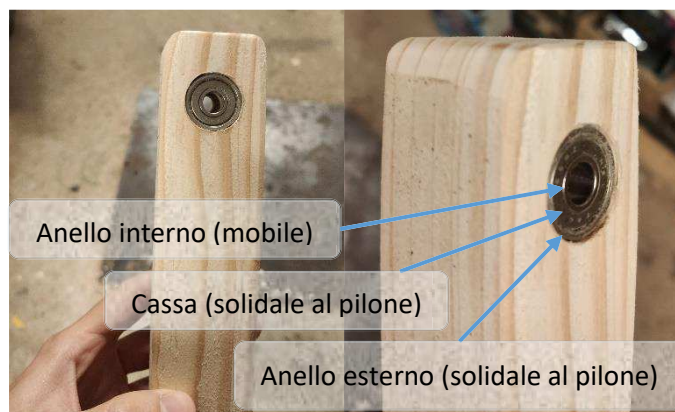
Figure 5.3 Cuscinetto incassato nel pilone
