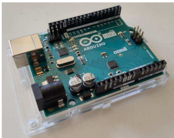
Figure 5.9 Scheda Arduino Uno
